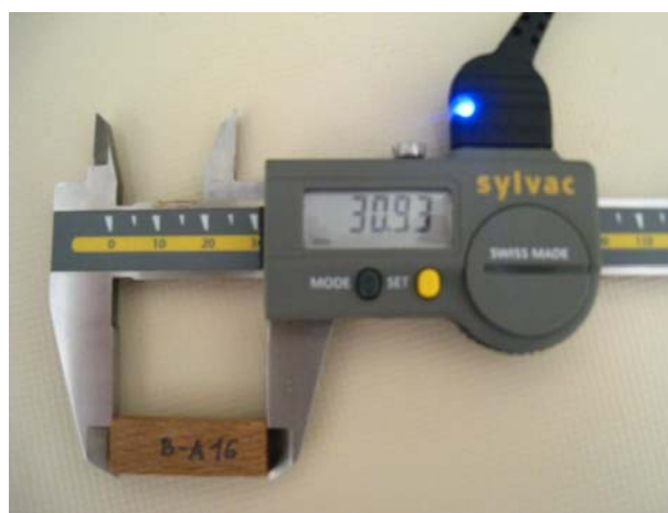
Slika 3: Elektronsko kljunasto merilo Sylvac (foto Matej Rozman)
