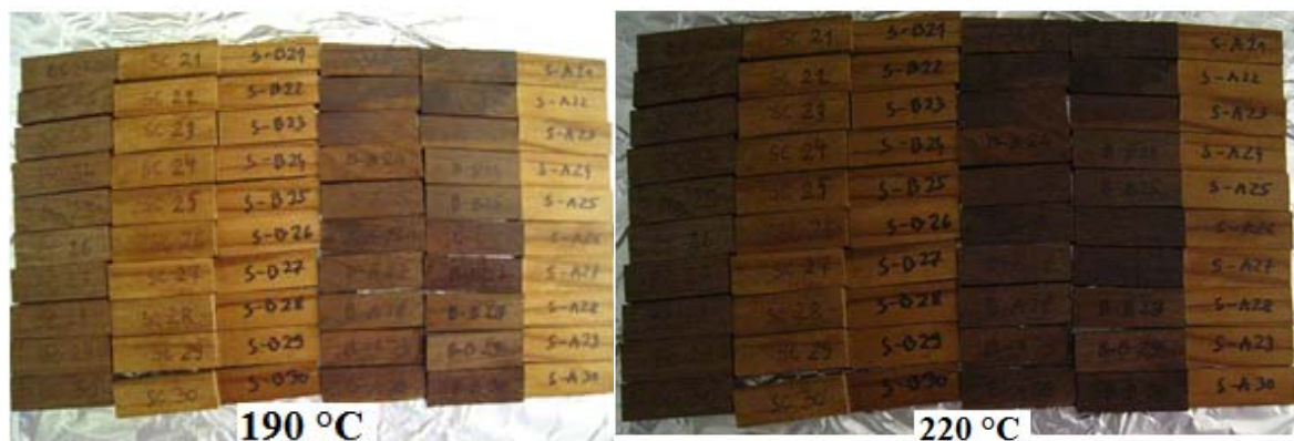
Slika 11: Prikaz barvne spremembe za vzorce smrekovine in bukovine po termični modifikaciji pri temperaturi 190 °C (na levi strani) in po modifikaciji pri 220 °C (na desni strani). (foto Matej Rozman)
