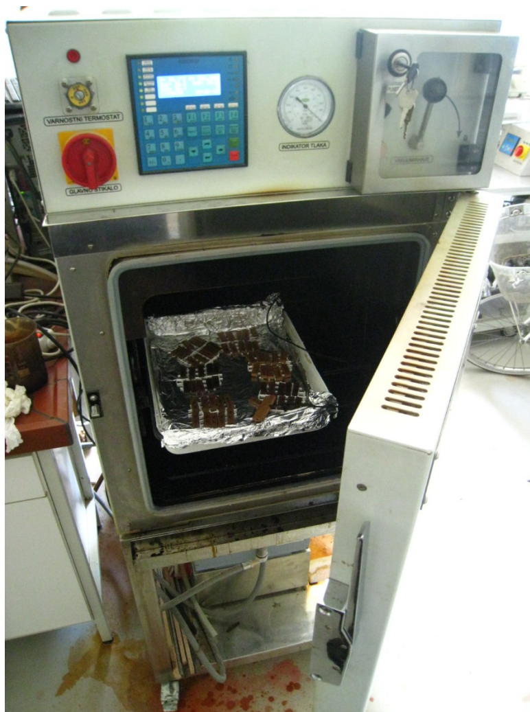
Slika 7: Komora za termično modifikacijo lesa (foto Matej Rozman)
