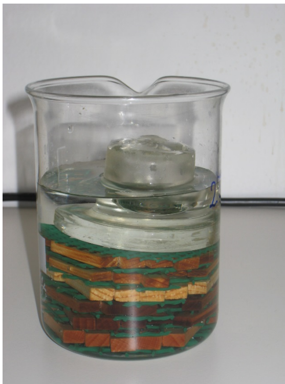
Slika 8: Proces namakanja v destilirani vodi (foto Matej Rozman)
