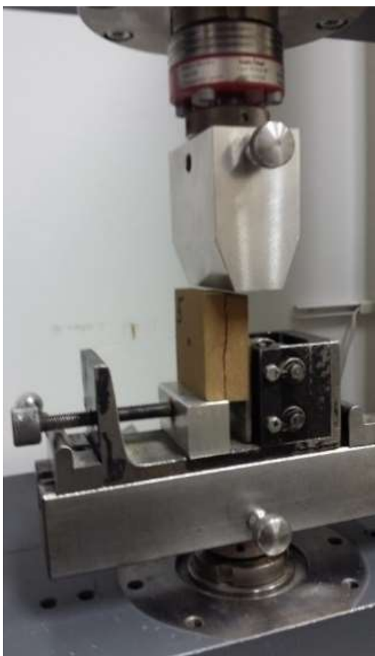
Slika 3: Primer loma preizkušanca na stroju ZWICK
