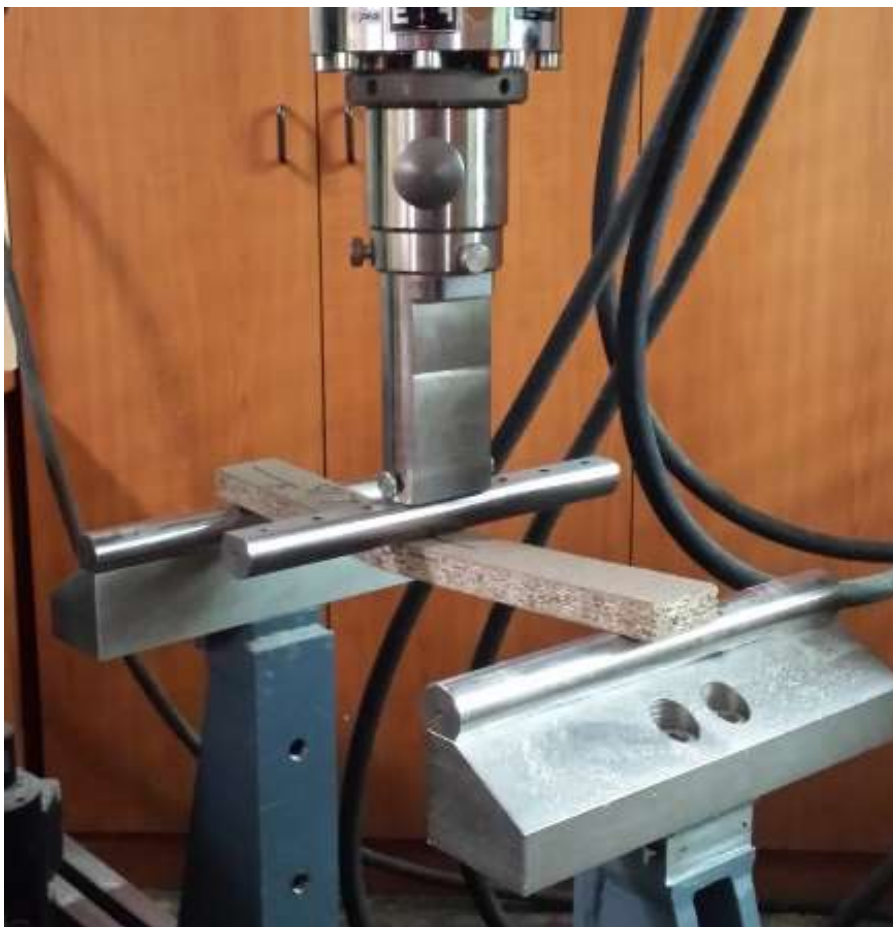
Slika 5: Preskušanec na testirnem stroju ZWICK Z100
