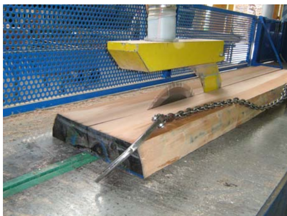
Slika 32: Razžagovanje drugega dela prizme s krožnim žagalnim strojem
