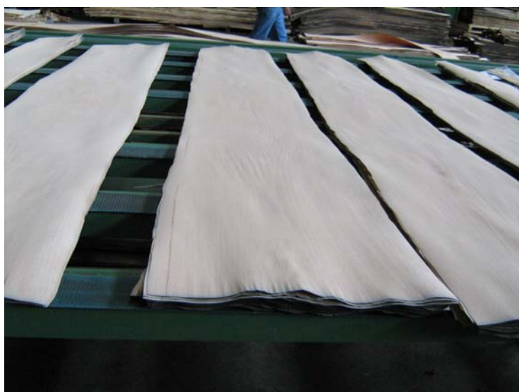
Slika 37: Zelo valovit furnir na transportnem traku na izhodu sušilnice
