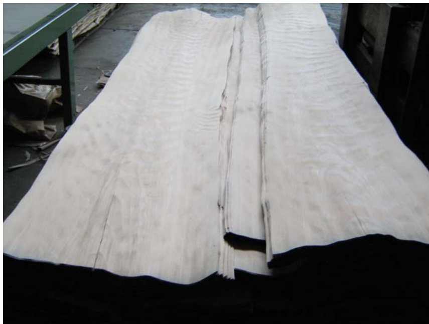
Slika 2: Furnir pripravljen za likanje na začetku linije za likanje
