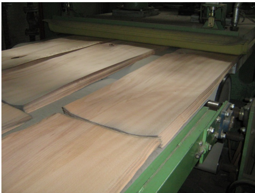
Slika 4: Pogled na izhodni del stiskalnice oziroma likalnice valovitega furnirja
