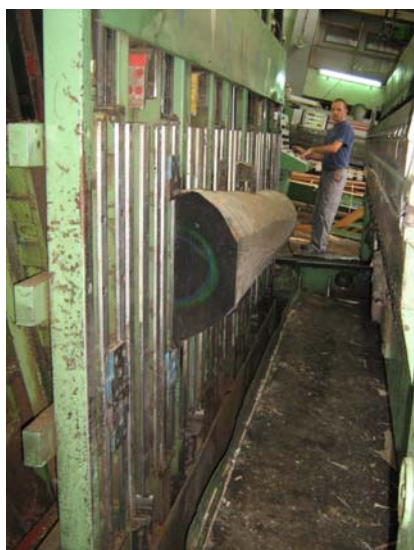
Slika 29: Vpetje polovice hloda v vertikalni furnirski rezalni stroj
