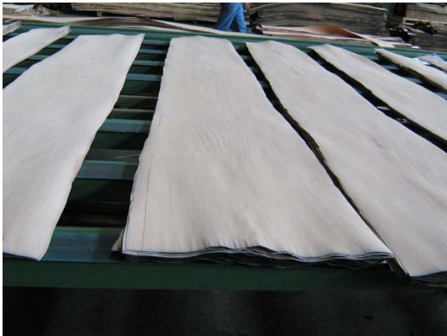
Slika 1: Na izhodnem transportnem traku lepo viden valovit furnir v paketih
