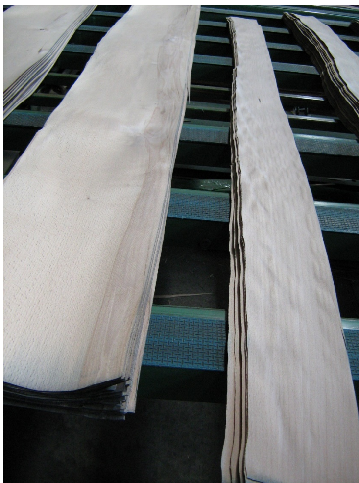
Slika 6: Vidna razlika med ravnim (levo) in valovitim furnirjem (desno)
