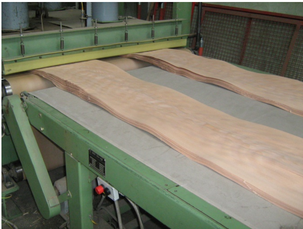
Slika 3: Pogled na vhod stiskalnice kjer se vrši likanje valovitega furnirja
