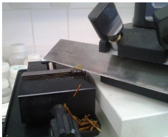
**Slika 12:** Rezanje preparatov na drsnem mikrotomu Leica SM 2000R
