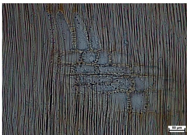
Slika 18: *Bowdichia* spp., radialno prerez: detajl heterogenega traku; daljica 50 µm
