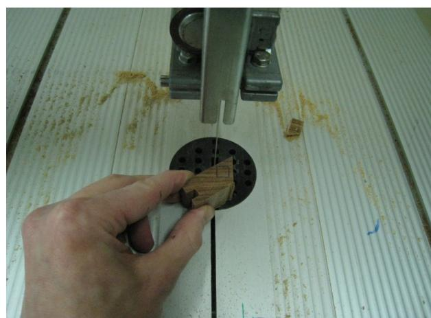
**Slika 11:** Tračni žagalni stroj; rezanje orientiranih količkov za izdelavo anatomskeih preparatov
