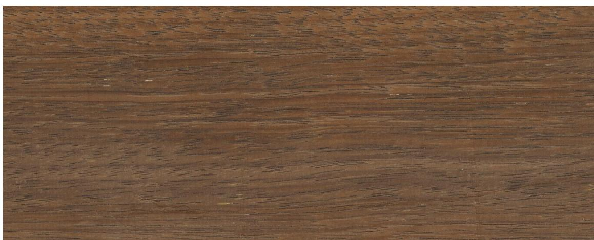
Slika 26: Vzorec 6 – trg. ime: merbau timber – *Intsia* spp., površina lesa
