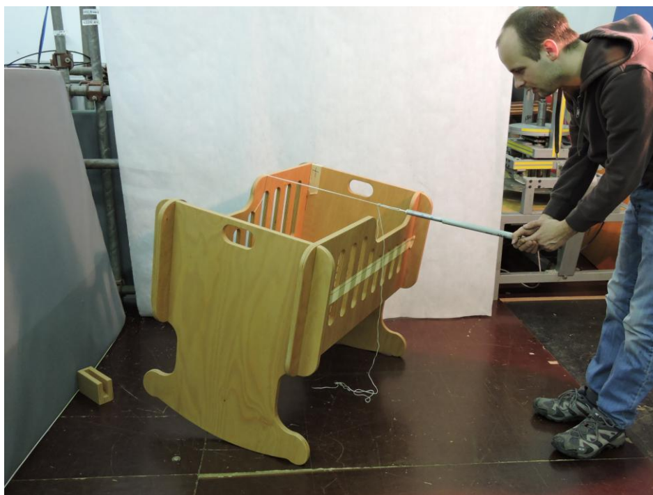
Slika 50: Test stabilnosti zibelke (foto: S. Rudolf)
