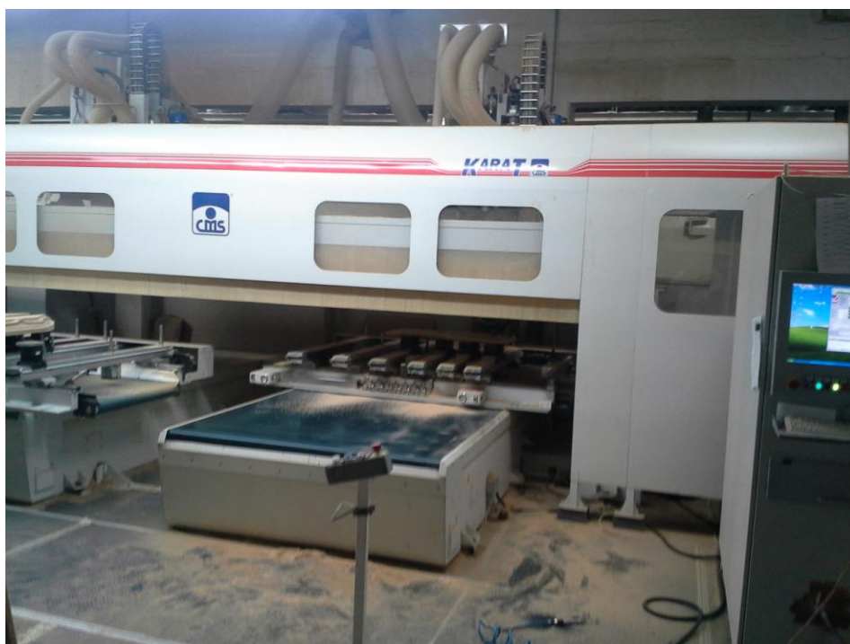
Slika 36: 5-osni CNC rezkalni stroj CMS z dvema pomičnima mizama
