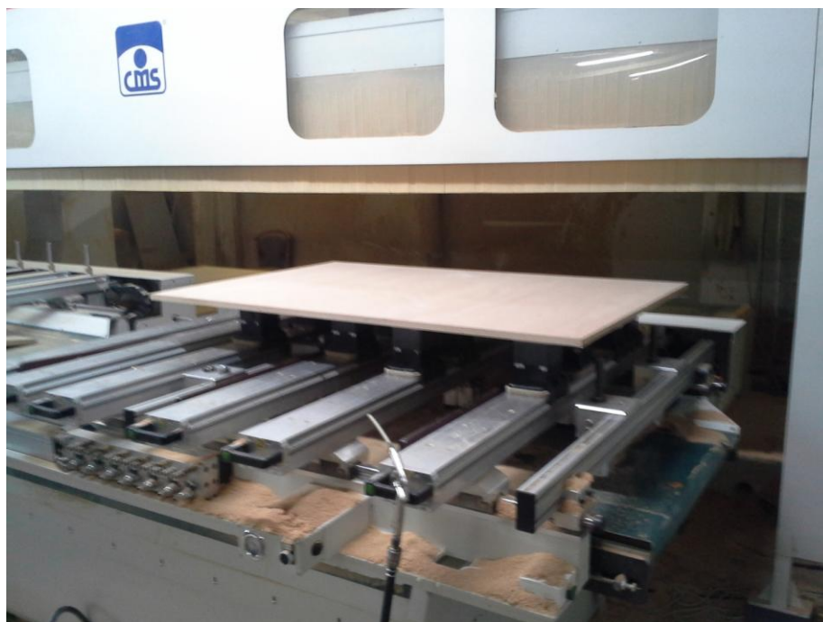
Slika 39: Stranica posteljice, nameščena na vakuumsko prijemala, pred rezkanjem
