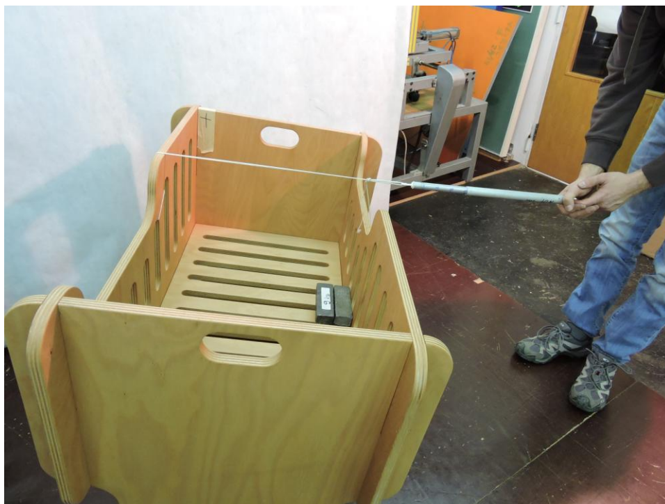
Slika 51: Test stabilnosti (foto: S. Rudolf)
