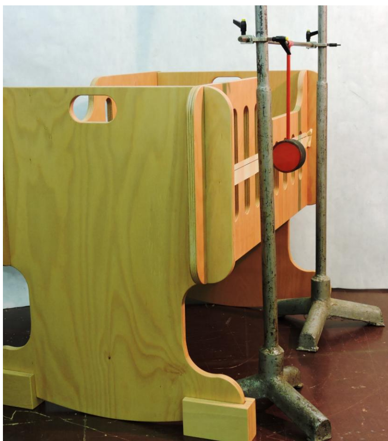
Slika 54: Udarni stranski test (foto: S. Rudolf)
