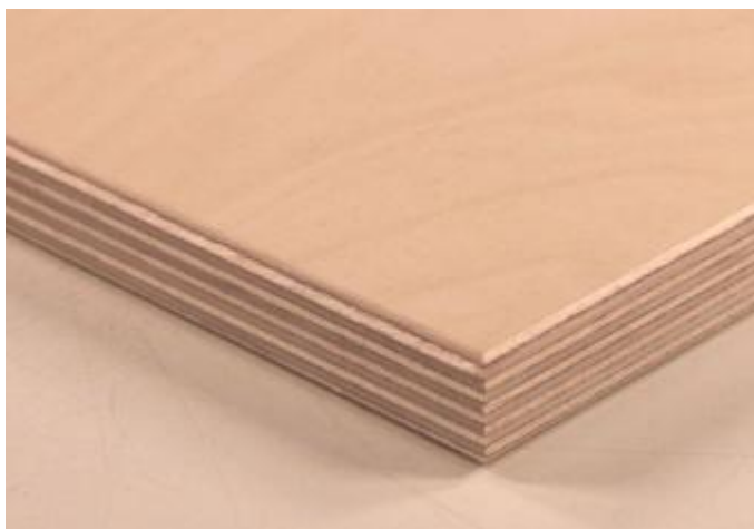
Slika 25: Bukova vezana furnirna plošča (Bukova ..., 2015)
