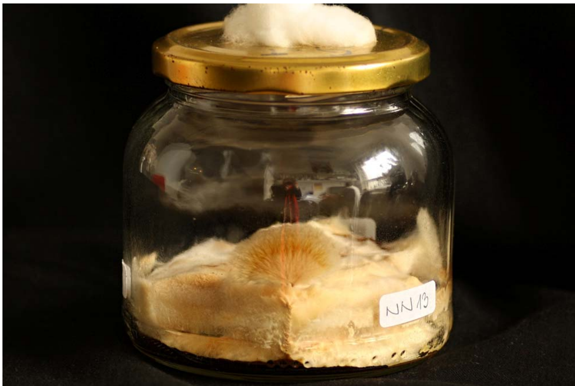
Slika 18: Navadna tramovka prekriva kontrolna vzorca skupaj z vzorcem impregniranim s poliestersko smolo.
