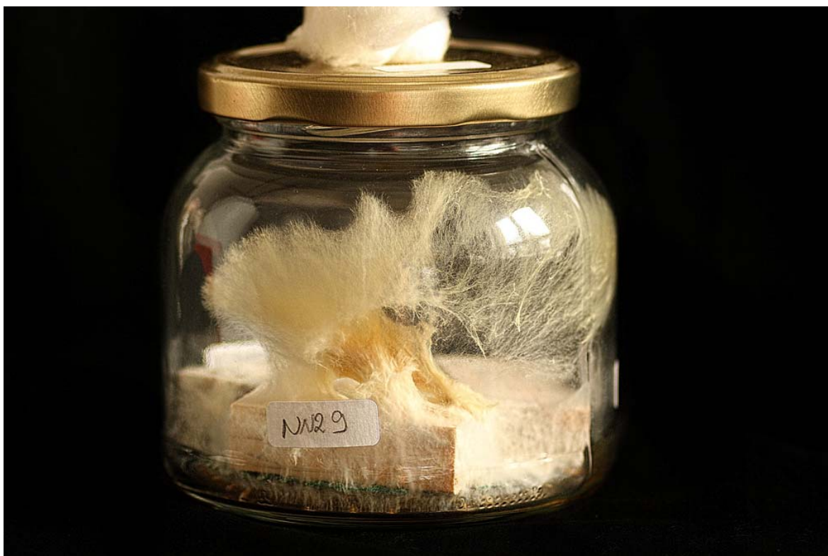
Slika 16: Bela hišna goba prekriva kontrolna vzorca v skupini z vzorcem impregniranim z epoksi smolo.
