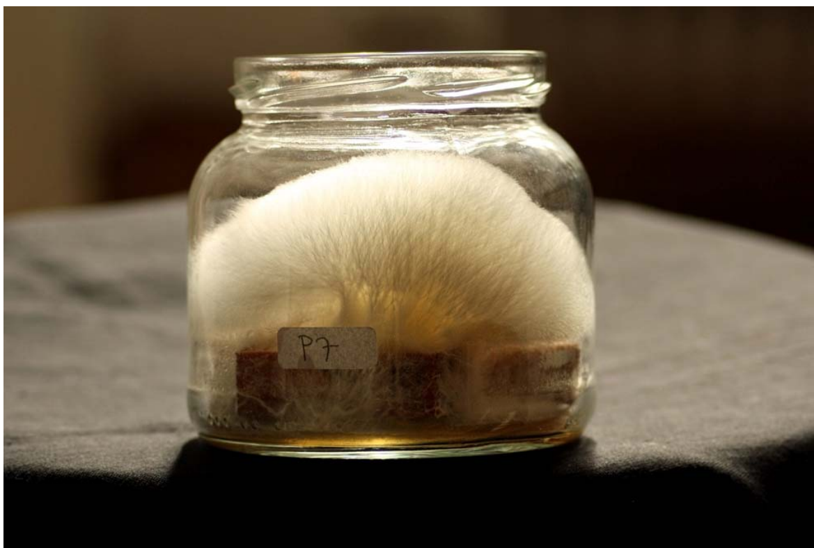
Slika 15: Bela hišna goba prekriva kontrolna vzorca in vzorec impregniran s poliestersko smolo
