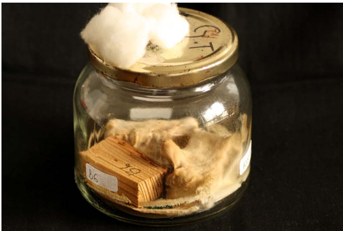
Slika 17: Navadna tramovka prekriva kontrolna vzorca. Vzorec impregniran z Utrjevalnim restavratorjem je skoraj nedotaknjen.
