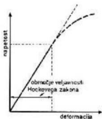
Slika 24: Odvisnost strižne napetosti od velikosti deformacije za idealno elastično snov - Hookov zakon (Kladnik, 1989)
