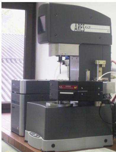
Slika 41: Reometer Ares G2, proizvajalca TA Instruments, uporabljen v raziskavi
