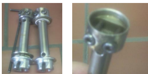
Slika 44: Čeljusti reometra ARES G2 za vpenjanje vzorcev (LEVO spodnja in zgornja čeljust s ključem za privijanje, DESNO glava čeljusti reometra z vijaki za pritrdjevanje diskov)
