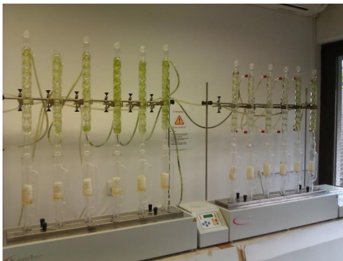
Slika 8: Ekstrahirajoči vzorci (Termo blok 6 – večpozicijsko grelnο mesto)
