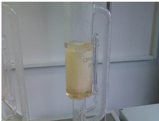
Slika 7: Označen celulozni tulec v Soxhletovem aparatu
