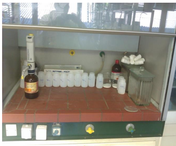
Slika 16: Digestorij, kjer smo izvajali dietilno ekstrakcijo
