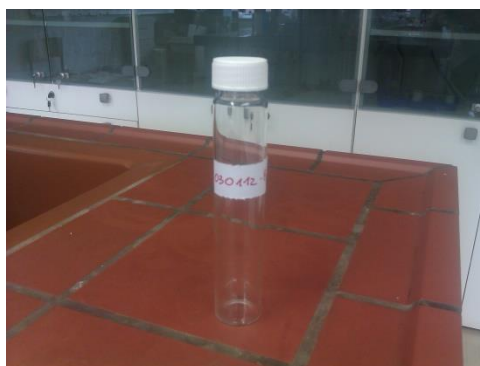
Slika 11: Označena steklenička, kamor smo odpipetirali 25 ml MeOH/H 2 O ekstrakta
