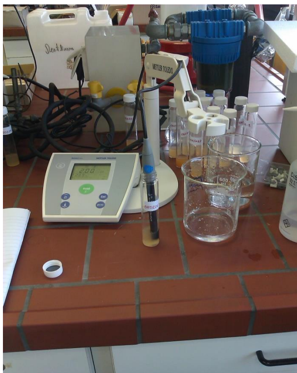
Slika 15: Kisanje vzorcev na želeni \text{pH} = 2 \pm 0.5
