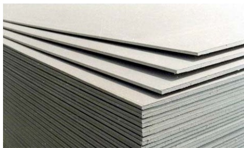
Slika 30: Mavčno kartonska plošča (Craftprocontracting, 2014)
