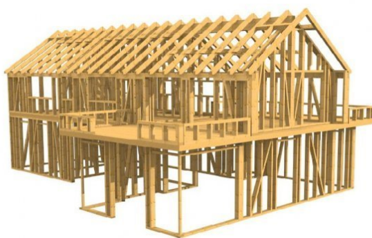
Slika 5: Skeletna konstrukcija (Damahaus, 2015)
