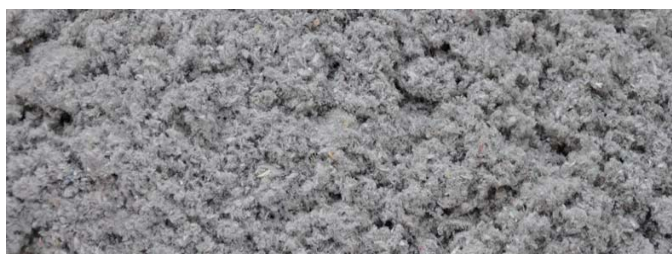
Slika 36: Celulozna toplotna izolacija (Ekoprodukt, 2014)
