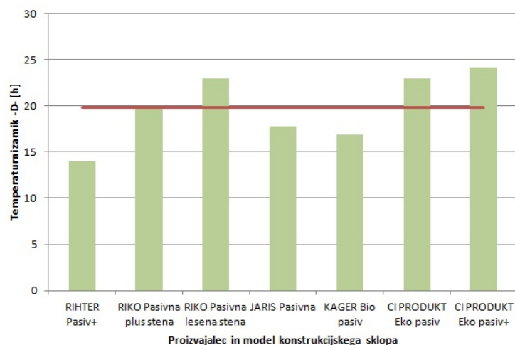
Slika 50: Primerjava temperaturnega zamika pasivnih konstrukcijskih sklopov. Vrednosti nad rdečo črto predstavljajo boljše konstrukcijske sklope.
