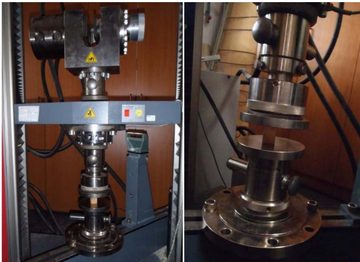
Slika 13: Naprava Zwick/Roell Z100 za določanje tlačne trdnosti (Foto: M. Žlahtič, 2013)
