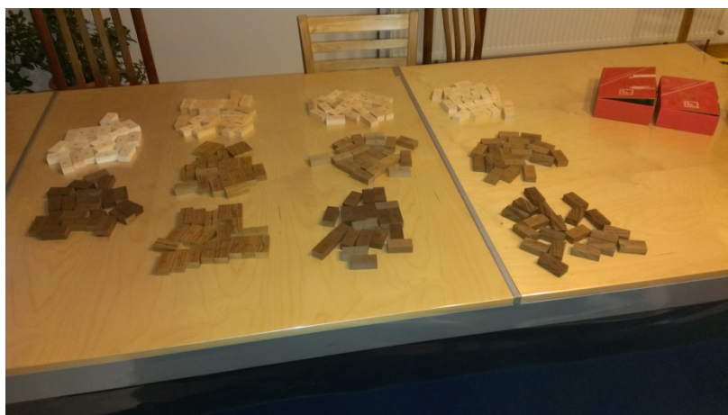
Slika 5: Kontrolni in termično modificirani vzorci jesena, topola, jelše in macesna (Foto: B. Lešnjak)
