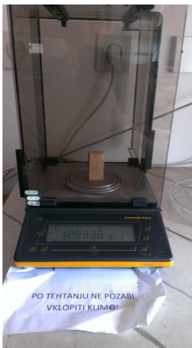
Slika 9: Tehtanje vzorcev po končanem sušenju (Foto: B. Lešnjak)
