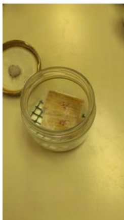
Slika 11: Bukova vzorca po 16 tednih inkubacije (Foto: B. Lešnjak)
