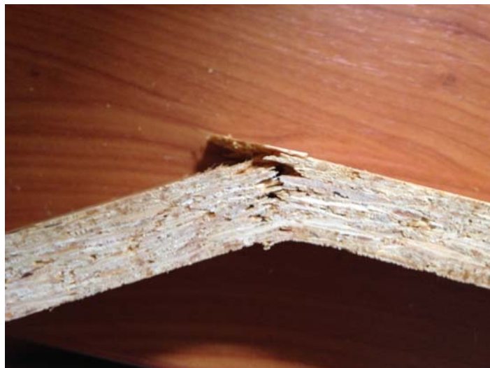
Slika 9: Izgled loma OSB plošče po upogibni obremenitvi
