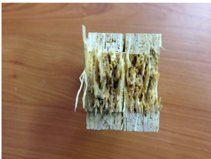
Slika 11: Izgled loma OSB plošče po natezni obremenitvi
