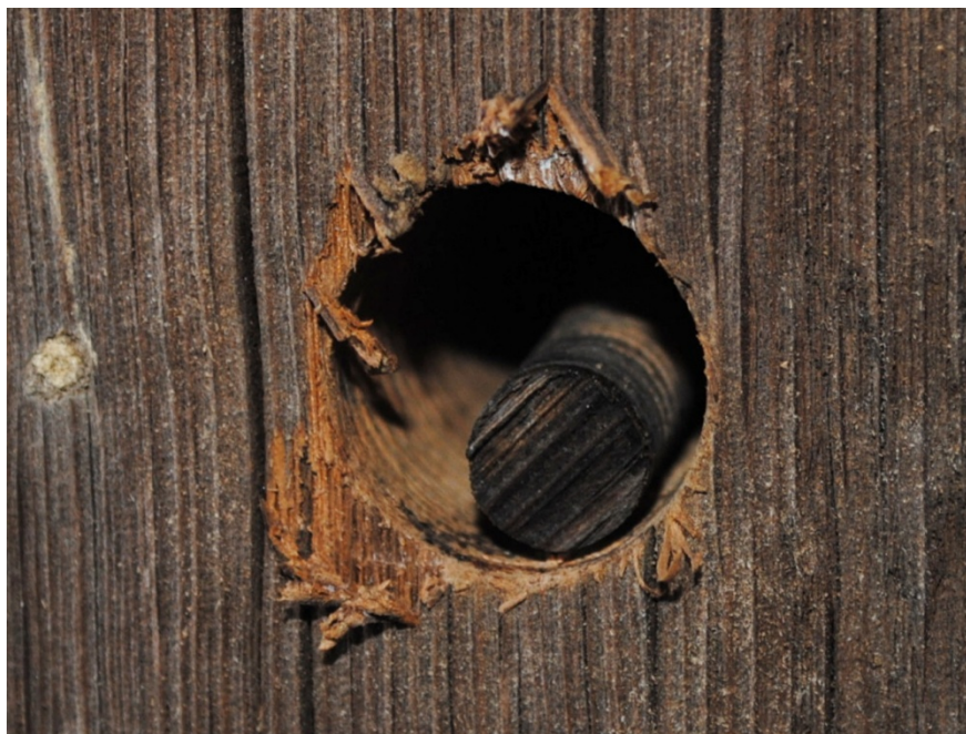
Slika 15: Idealno izvrtan vzorec ostane v izvrtini.
