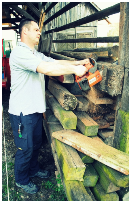
Slika 14: Odvzem odrezka iz stegnjenega kozolca.
