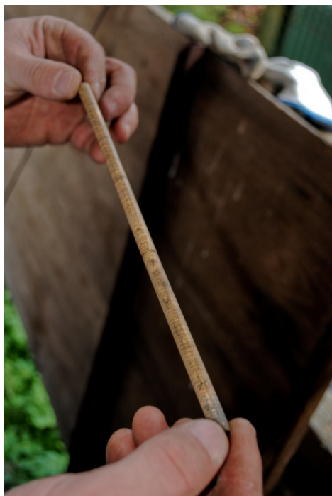
Slika 13: Pravilno izdelan izvrtok.
