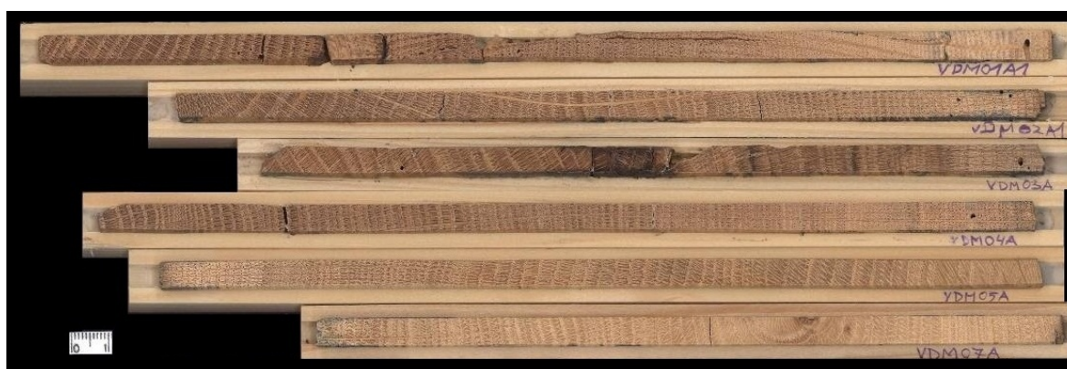
Slika 29: Izvrтки Vdmkovega kozolca.
