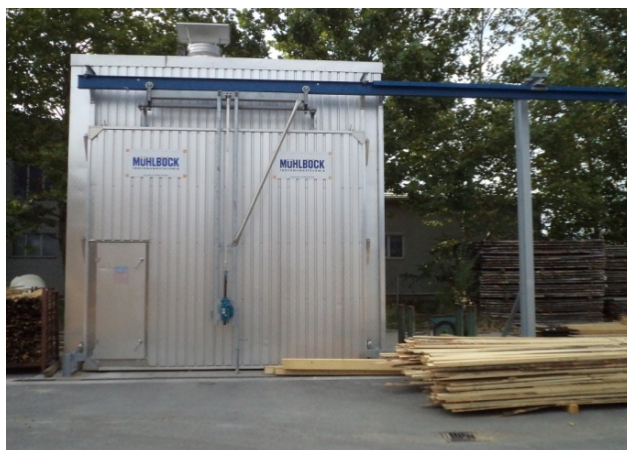
Slika 16: Konvencionalna sušilna komora podjetja.
