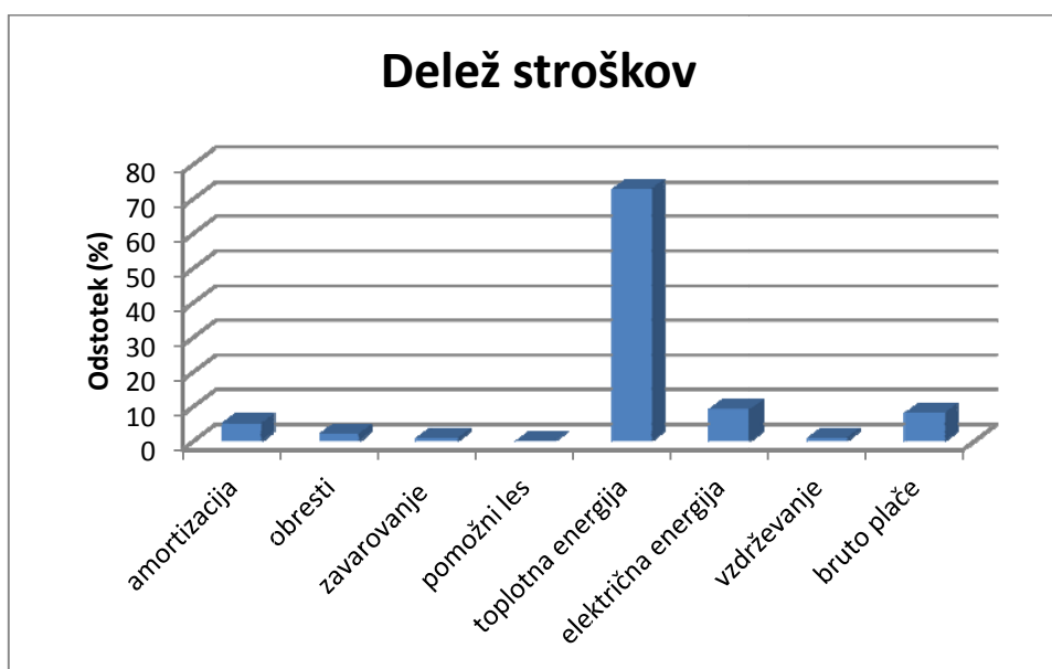
Slika 17: Stolpčni prikaz deležev stroškov konvencionalnega sušenja
