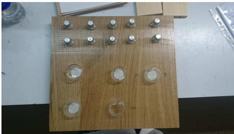
Slika 10: Preskušanje oprijemnosti (zgoraj) in odpornosti proti tekočinam (spodaj) na hrastovi podlagi
