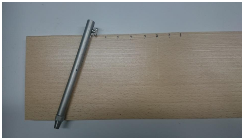
Slika 12: Preskušanje odpornosti proti razenju na podlagi iz bukovega lesa
