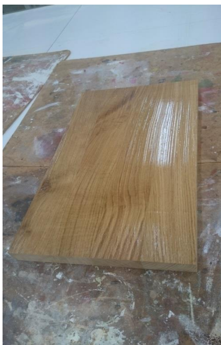
Slika 9: Hrastov vzorec po premazovanju
