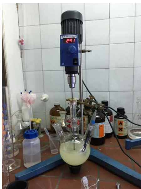
Slika 11: Trogrla bučka opremljena z mehanskim mešalom in pH metrom med potekom reakcije TEMPO oksidacije
