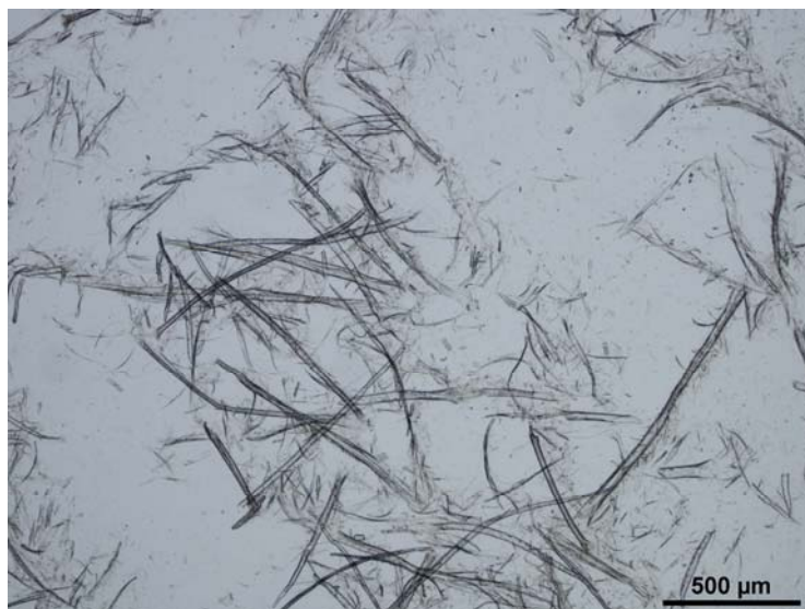
Slika 194: Vzorec TEMPO oksidirane celuloze juvenilnega lesa vzorca 2/3. V vzorcu je mogoče prepoznati različno velike vlaknaste delce ter fragmente, ki so daljši od 500 \mu\text{m} , fragmente celične stene in tudi komaj vidne dele vlaken. Opazili smo tudi gelasto snov, ki pa jo z svetlobnim mikroskopom ni bilo mogoče vizualizirati.
