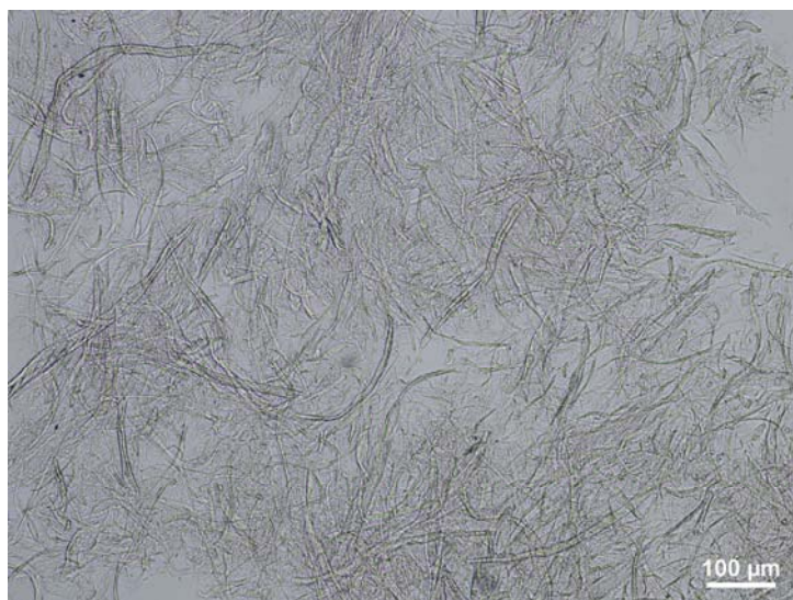
Slika 216: Nikoli sušena, TEMPO oksidirana celuloza. Zmes še vedno vsebuje fragmente celuloznih vlaken, ki pa so bistveno krajši, kot v primeru sušene celuloze.
