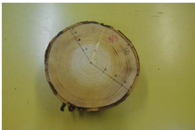
Slika 4: Primer označenega koluta 3/3, na kolutu so označene dekade.
