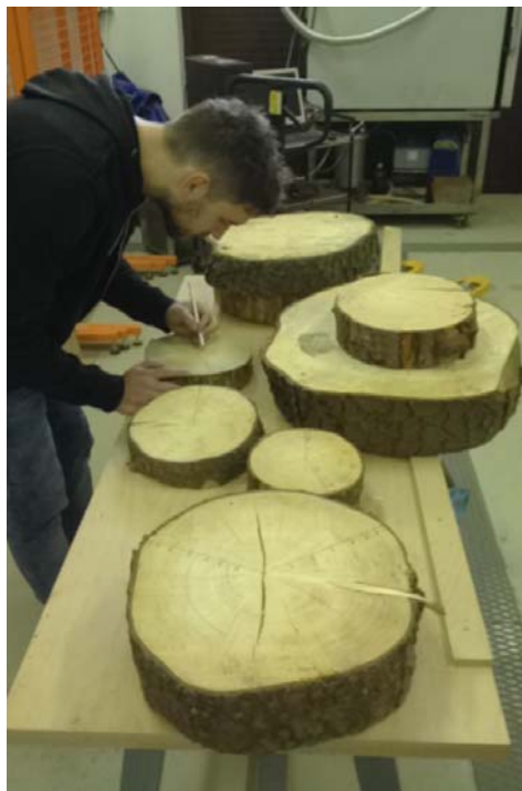
Slika 3: Označevanje vzorcev in razmejevanje adultnega in juvenilnega lesa
