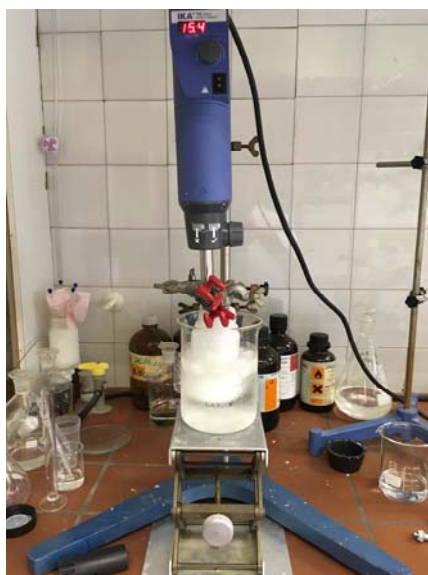
Slika 13: Mehanska obdelava TEMPO oksidirane celuloze z ultraturaksom.
