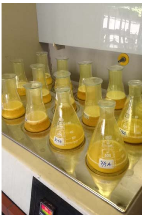
Slika 8: Erlenmajerice na vodni kopeli med postopkom delignifikacije
