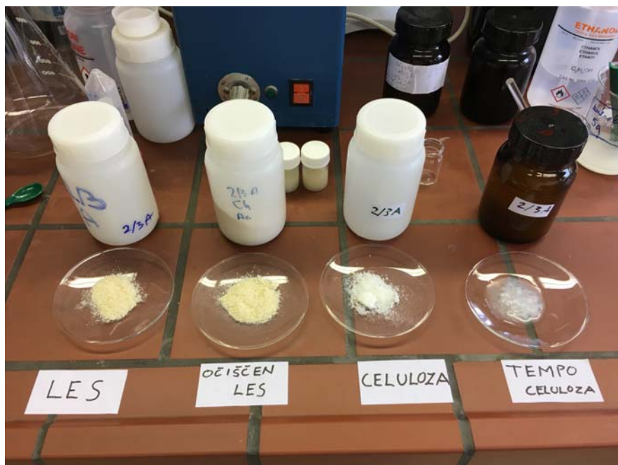
Slika 179: Makroskopski prikaz vhodne surovine in produktov po vsaki fazi obdelave.
