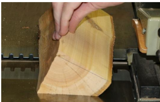
Slika 9: Orientiranje vzorcev na poravnalnem skobeljnem stroju.
