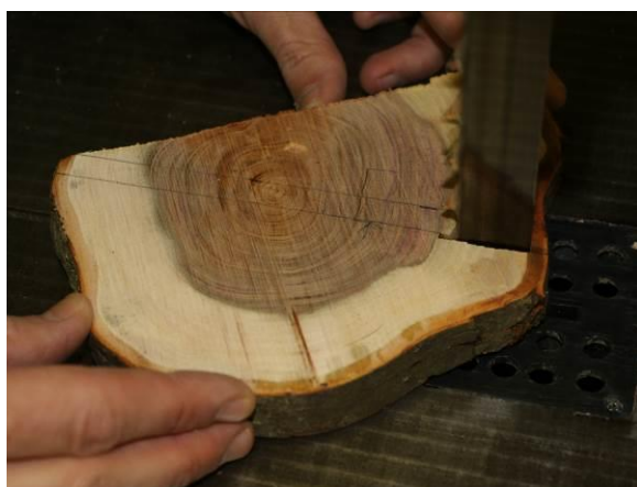
Slika 2: Obdelava na tračnem žagalnem stroju; izžagovanje vzorcev za izdelavo preparatov.
