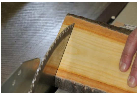
Slika 10: Poravnava čel na krožnem žagalnem stroju in brušenje vzorcev na tračnem brusilnem stroju (od leve proti desni).
