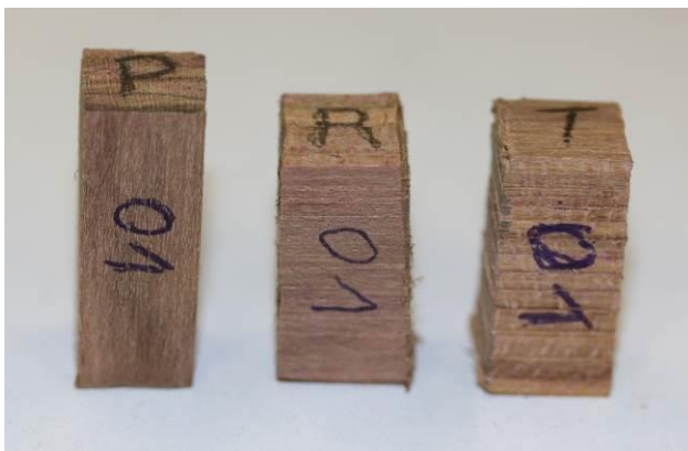
Slika 3: Prečno, radialno in tangencialno orientirani koščki lesa pred namakanjem v t.i. mehčalnem mediju.
