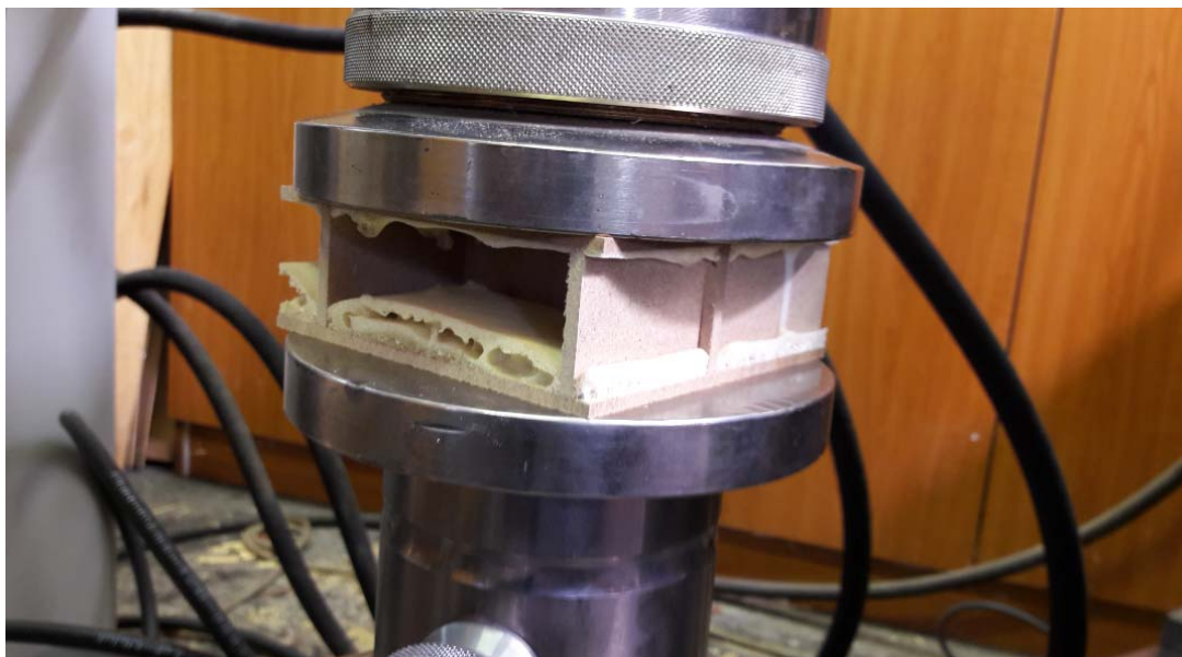
Slika 28: Tlačno obremenjevanje plošče z MDF mrežo
