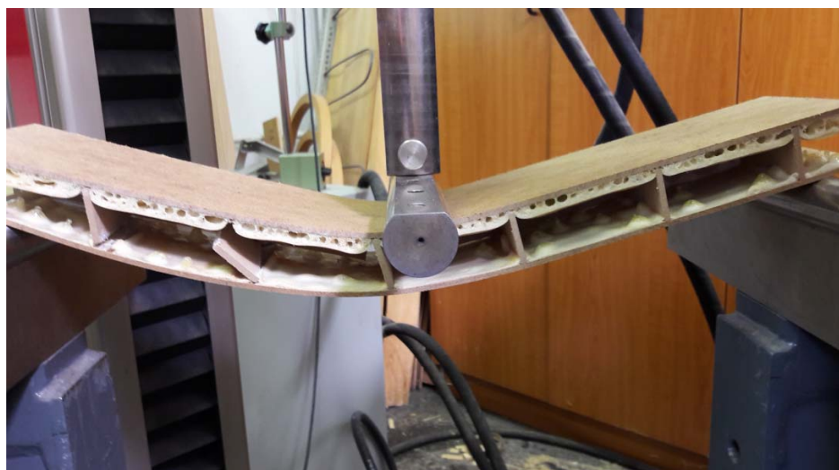
Slika 20: Prikaz upogibne obremenitve plošče z MDF mrežo
