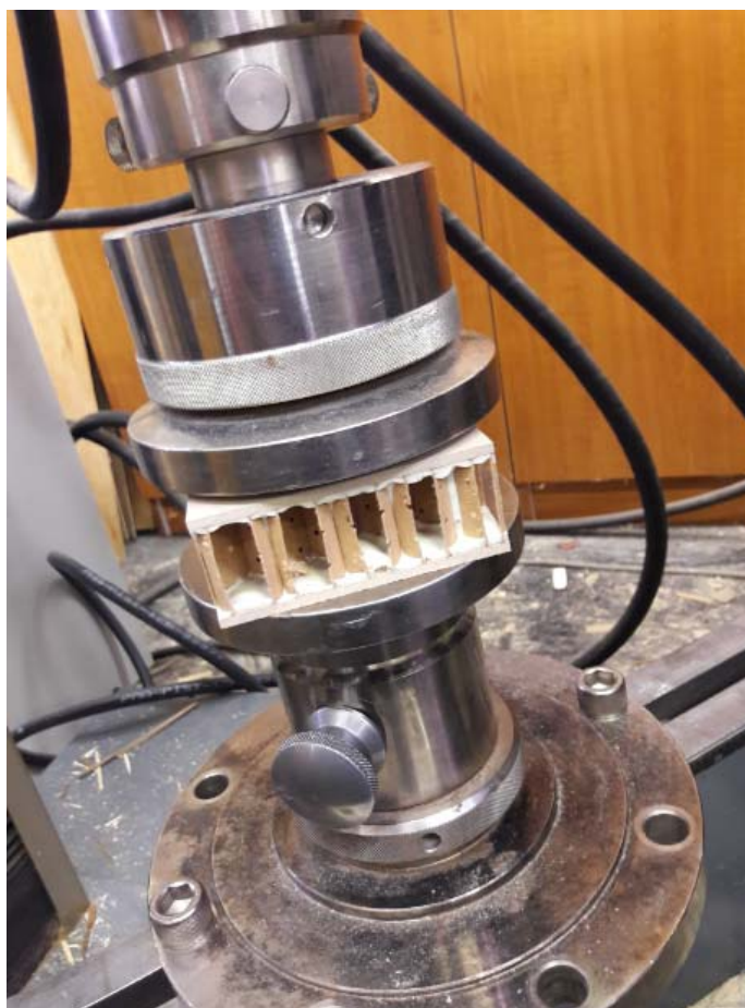
Slika 12: Preizkus tlačne trdnosti preizkušanca s papirnatim satovjem
