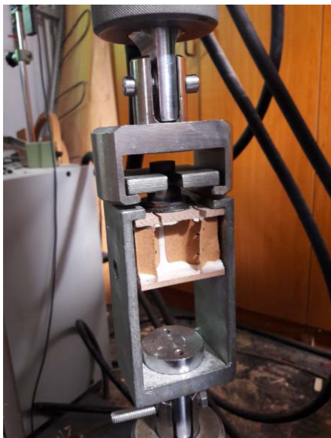
Slika 36: Izvajanje preizkusa čvrstosti površine
