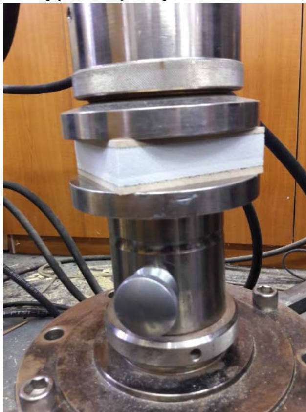
Slika 27: Tlačno obremenjevanje plošče s sredico iz EPS-a
