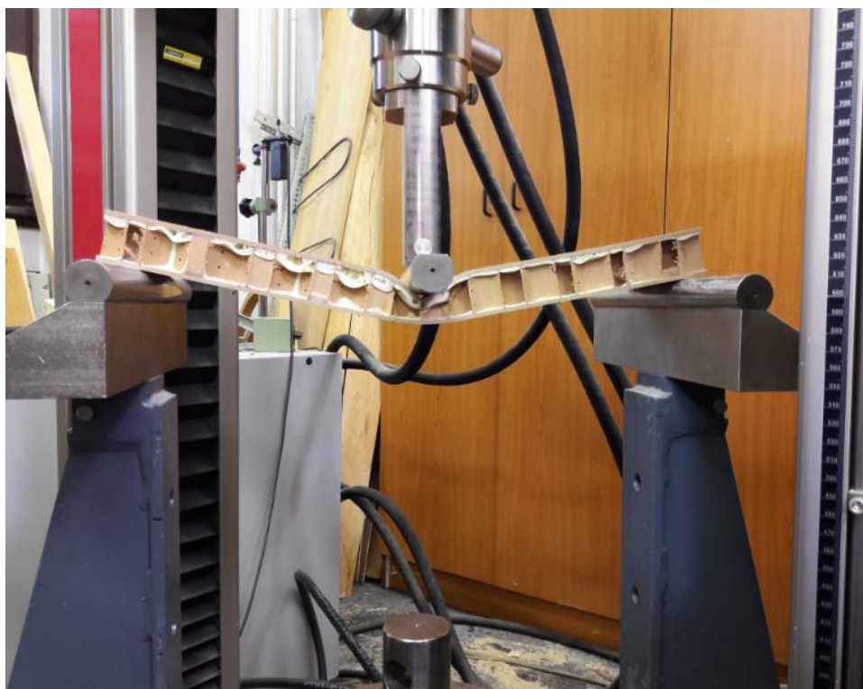
Slika 18: Prikaz upogibne obremenitve plošče s sredico iz papirnatega satovja
