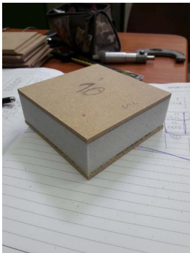
Slika 10: Preizkušane velikosti 100 mm x 100 mm, pripravljen na meritev dimenzij
