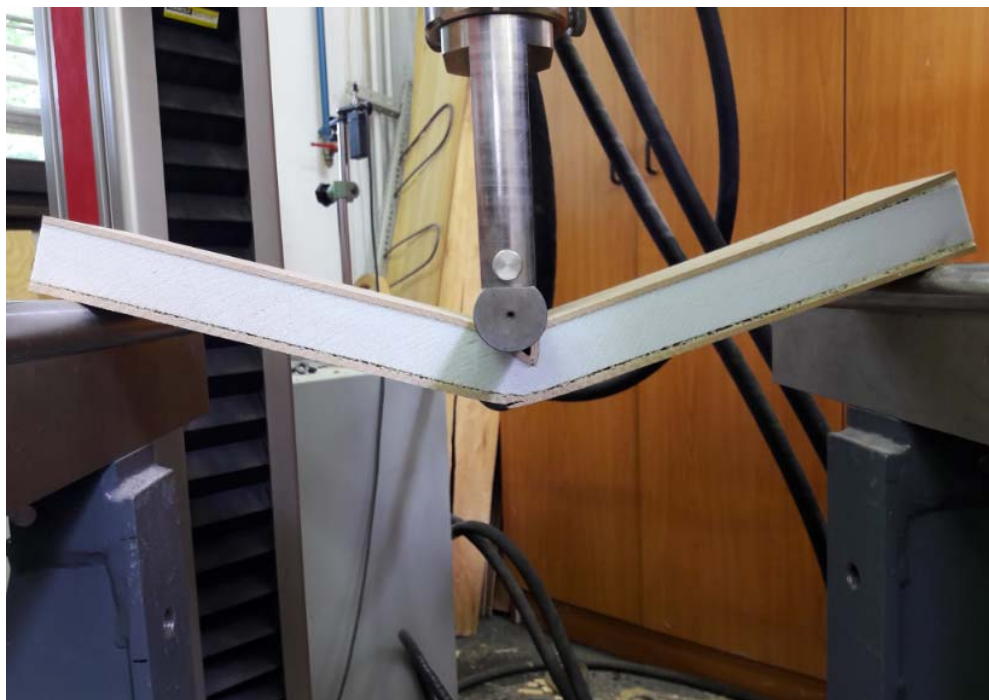
Slika 19: Prikaz upogibne obremenitve plošče s sredico iz EPS-a
