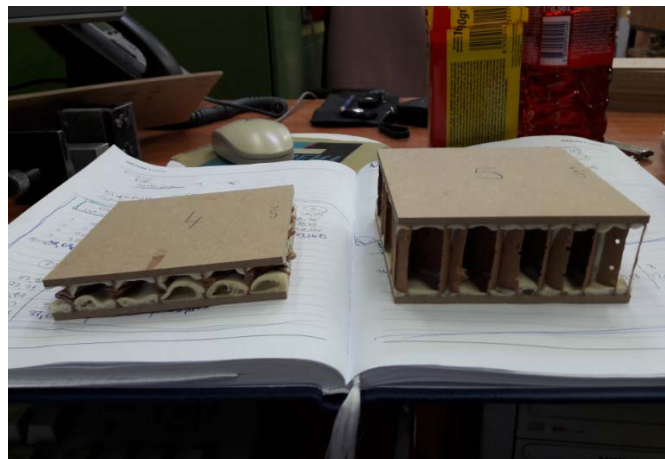
Slika 25: Prikaz deformacije pri tlačni obremenitvi
