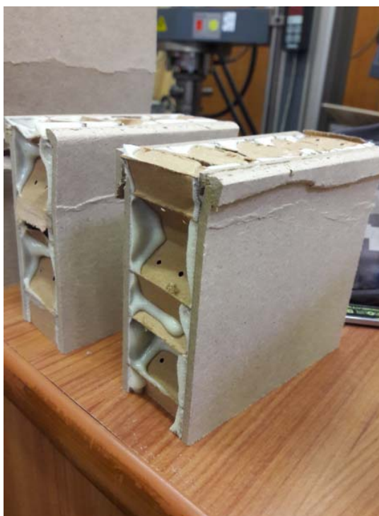
Slika 31: Prikaz loma plošče s sredico iz papirnatega satovja zaradi obremenjevanja po robu
