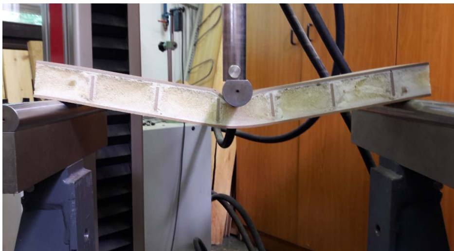
Slika 21: Prikaz upogibne obremenitve plošče z MDF mrežo in PUR peno
