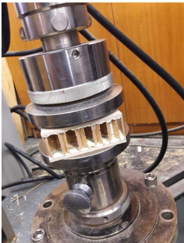
Slika 26: Tlačno obremenjevanje plošče s sredico iz papirnatega satovja
