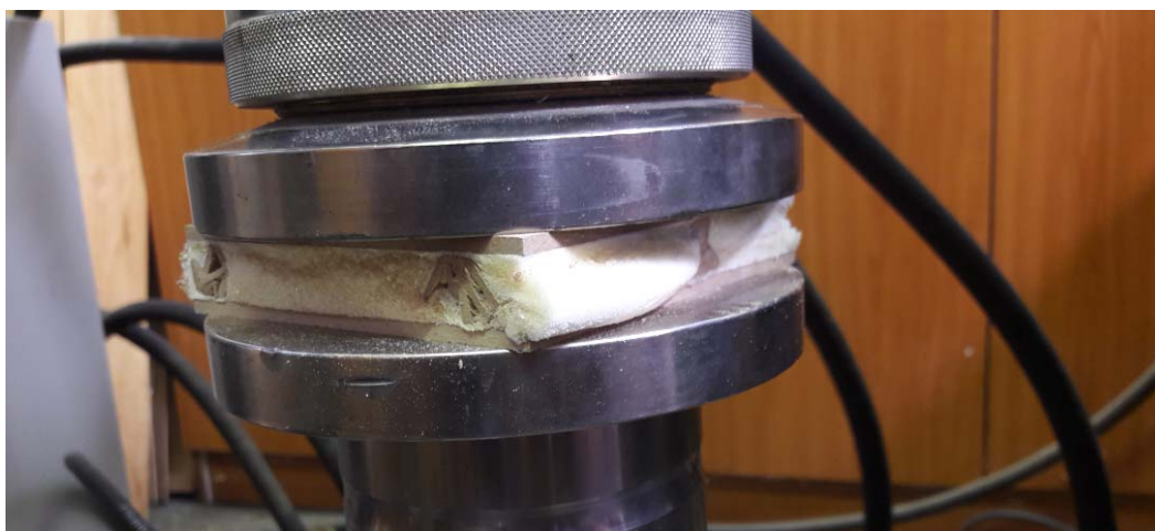
Slika 30: Preizkus tlačne trdnosti preizkušanca zasnovanega v laboratoriju
