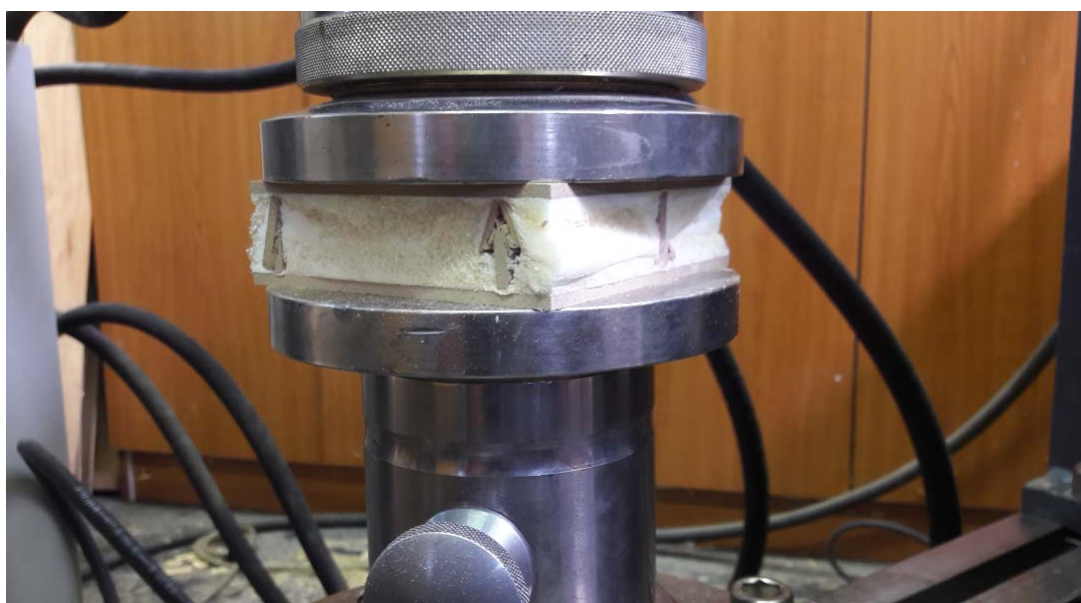
Slika 29: Tlačno obremenjevanje po ploskvi plošče z MDF mrežo in PUR peno
