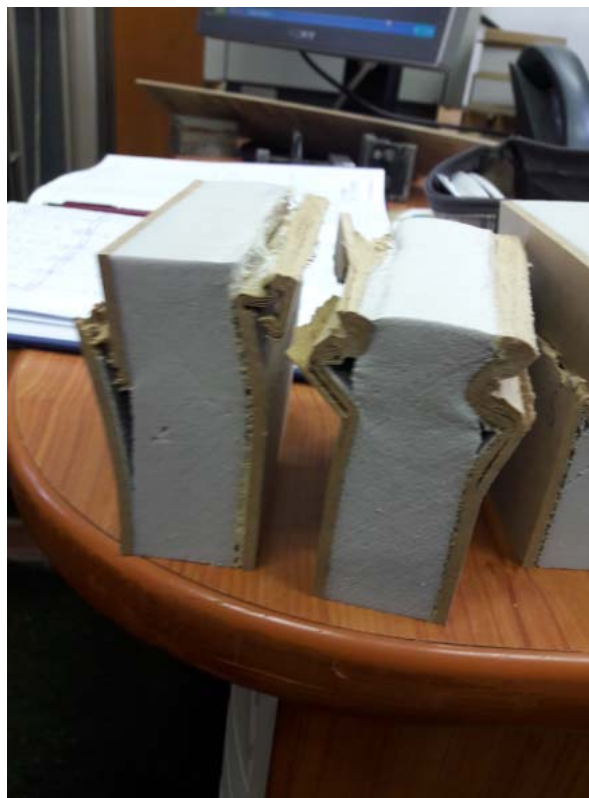
Slika 32: Prikaz loma plošče s sredico iz EPS zaradi obremenjevanja po robu
