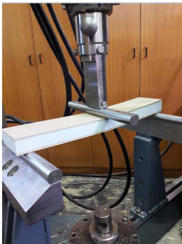
Slika 11: Preizkus upogibne trdnosti plošče s sredico iz EPS
