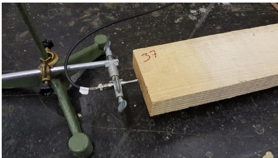
Slika 15: Postavitev mikrofona pri longitudinalnem vzbujanju.
