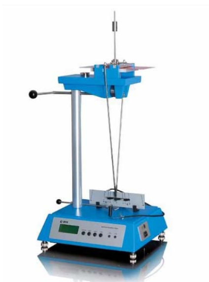
Slika 7: Königovo nihalo za določanje trdote premaznega sredstva (Tecnos, 2016).
