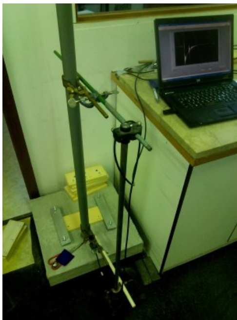
Slika 11: Izvedba dinamičnega eksperimenta s spuščanjem kroglice.
