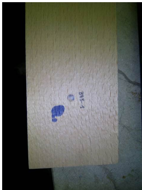
Slika 13: Izgled površine preizkušanca po testiranju trdote z dinamično metodo (levo) in po Brinellovi metodi (desno).
