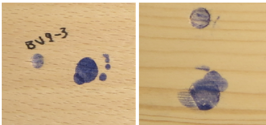
Slika 18: Primerjava vtiskov kroglice po Brinellu in pri dinamični metodi pri bukovini (levo) in smrekovini (desno)
