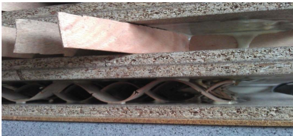
Slika 23: Prikaz zapolnjevanja neravnin pri lepilnih površinah
