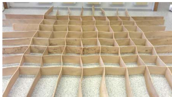
Slika 20: Mrežasto satovje z razmikom celic 10 cm (levo) in satovje razmikom celic 5 cm (desno)
