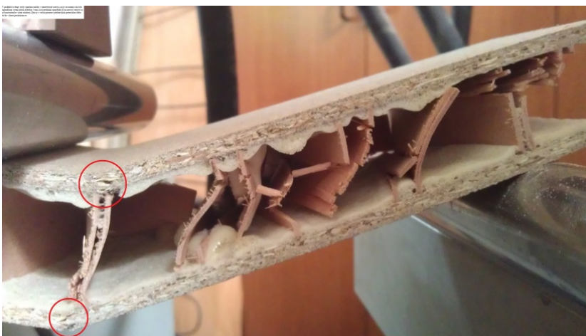
Slika 33: Porušitev vzorca s prečno orientiranim satovjem
