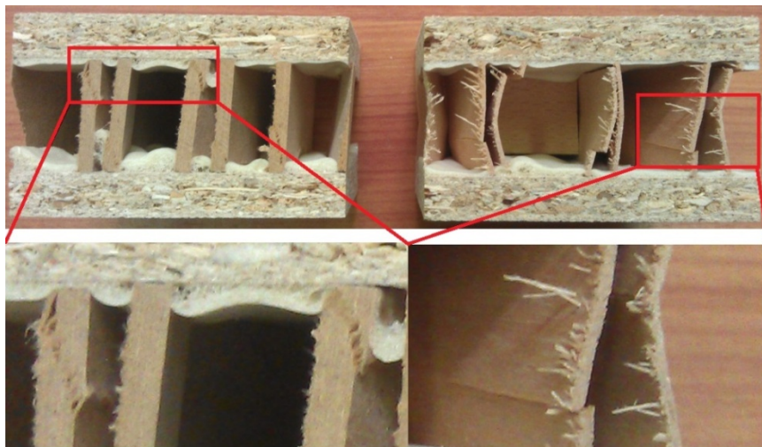
Slika 30: Primerjava vzorcev po končani tlačni obremenitvi: UNO MDF satovje (levo), UNO F satovje (desno)
