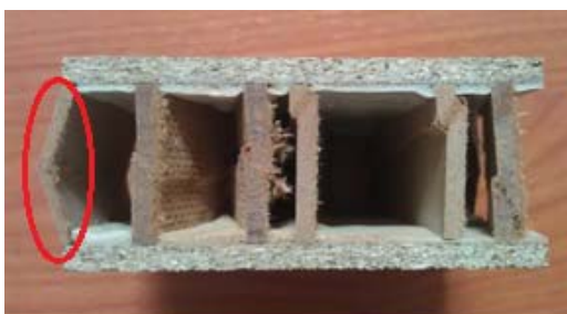
Slika 39: Uklon in lom stanjšane traku UNO MDF satovja
