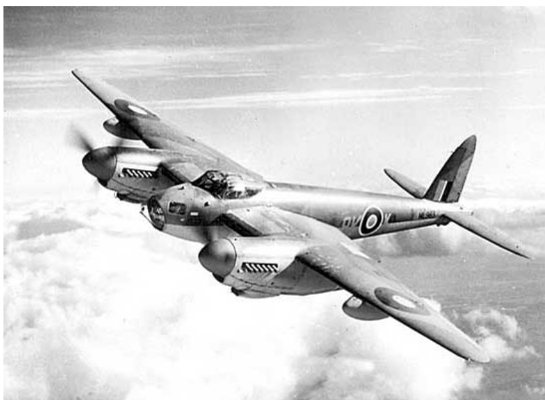
Slika 7: Letalo z lesenim skeletom imenovano: Mosquito bommbler (bombno letalo iz druge svetovne vojne: Mosquito, 2013)
