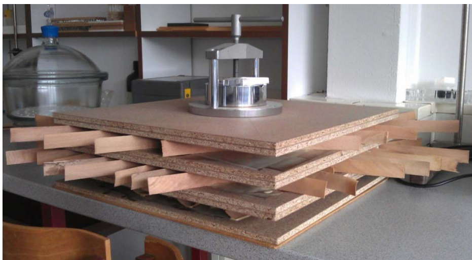
Slika 22: Obteževanje sestavljenih elementov med lepljenjem
