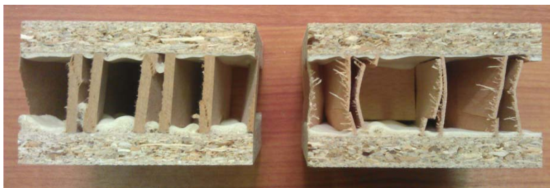
Slika 38: Primerjava loma MDF (levo) in furnirnega satovja (desno)
