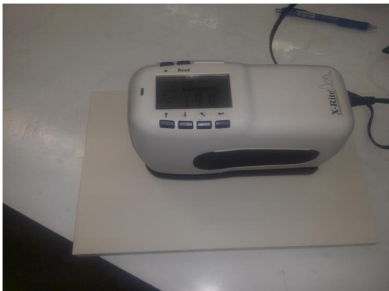
Slika 11: Spektrofotometer SP62 (proizvajalec X-Rite GmbH – OPTRONIK™).
