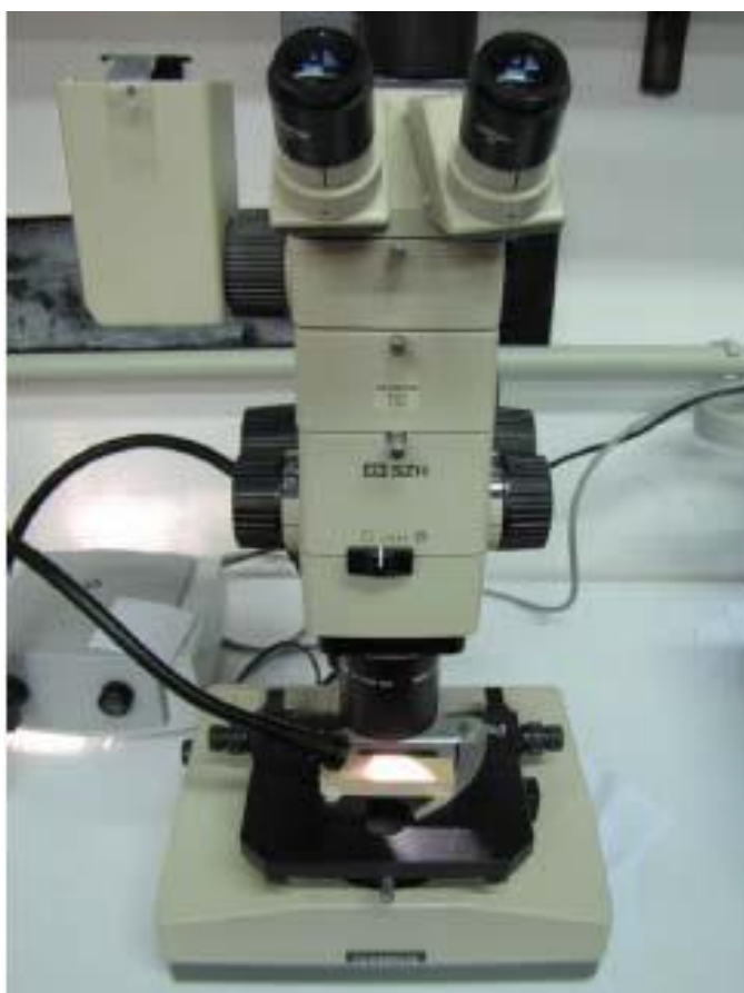
Slika 7: Stereomikroskop Olympus SZH z dodatno osvetlitvijo.
