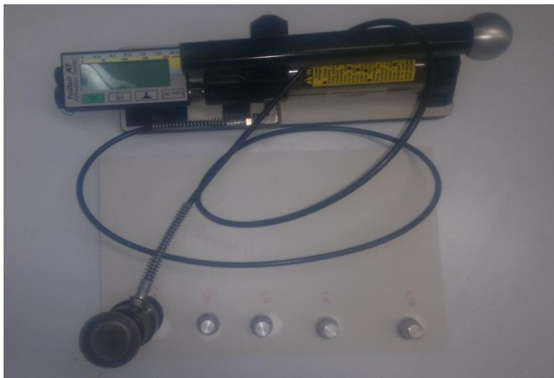
Slika 9: DeFelsco PosiTest AT Adhesion Tester, naprava za odtrgovanje pečatov.
