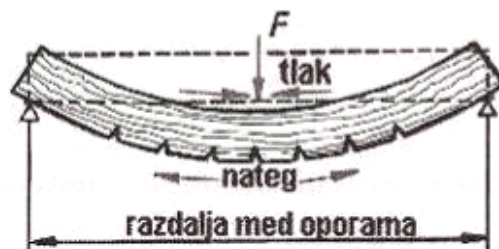
Slika 14: Ponazoritev porušitve na natezno obremenjeni strani preizkušanca (Polanc, Leban, 2004)
