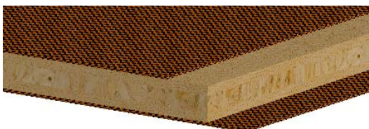
Slika 18: Shematski prikaz sestave plošče C 3
