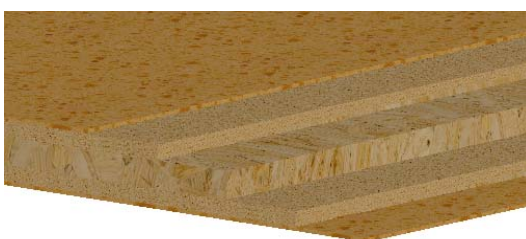
Slika 10: Shematski prikaz sestave plošče B 1
