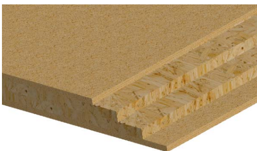
Slika 9: Shematski prikaz sestave plošče A 2.2
