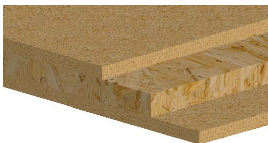
Slika 8: Shematski prikaz sestave plošče A 2.1
