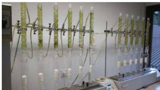
Slika 18: Soxhletov aparat med ekstrakcijo s cikloheksanskim topilom.
