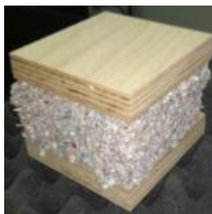
Slika 18: Celulozna in furnirna plošča
