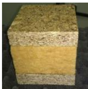
Slika 22: Klasična in konstrukcijska plošča
