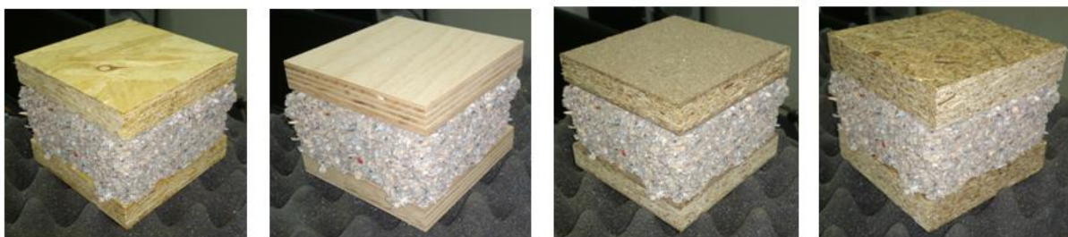
Slika 33: Panelni sistem: komercialna plošča + celulozna plošča + komercialna plošča
