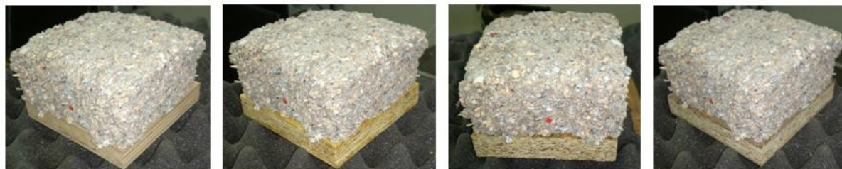
Slika 31: Panelni sistemi iz celulozne sredice in zunanje plasti iz komercialnih plošč
