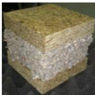
Slika 15: Celulozna in konstrukcijska plošča
