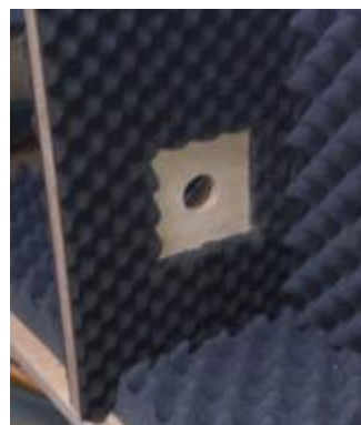
Slika 23: Prostor za nameščanje vzorcev
