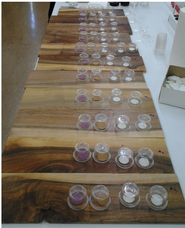
Slika 10: Določevanje odpornosti površine proti hladnim tekočinam
