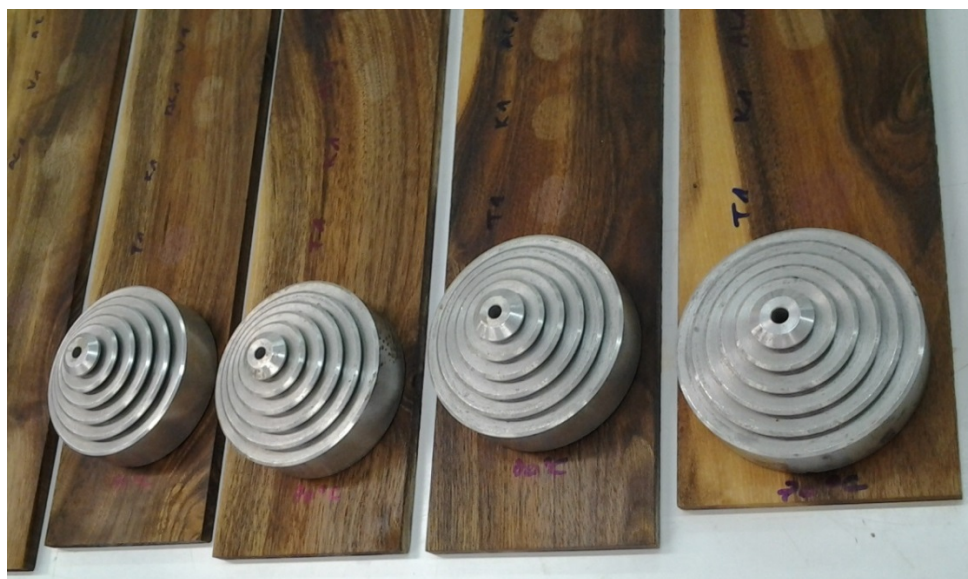
Slika 11: Določevanje odpornosti površine proti suhi toploti
