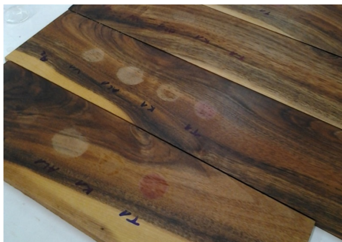
Slika 18: Vzorci po izpostavitvi hladnim tekočinam (po vrsti od spodaj navzgor: laneno olje, laneni firnež, tungovo olje)
