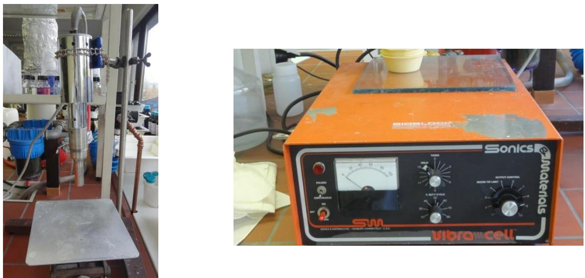
Slika 2: Ultrazvočna sonda Vibra Cell
