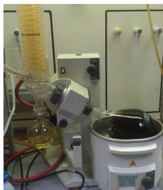
Slika 11: Rotavapiranje oz. odparjevanje nezreagiranih topil
