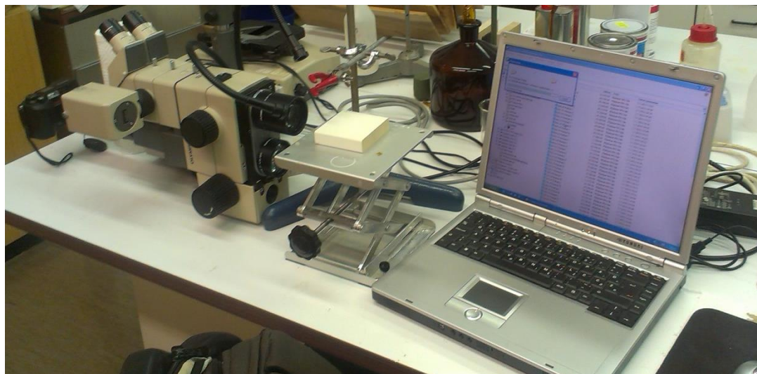
Slika 33: Stereomikroskop Olympus SZH z računalniškim zajemom slike stičnega kota
