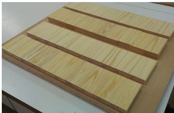
Slika 31: Vzorci lesa bora in smreke, pripravljeni za določanje stičnega kota
