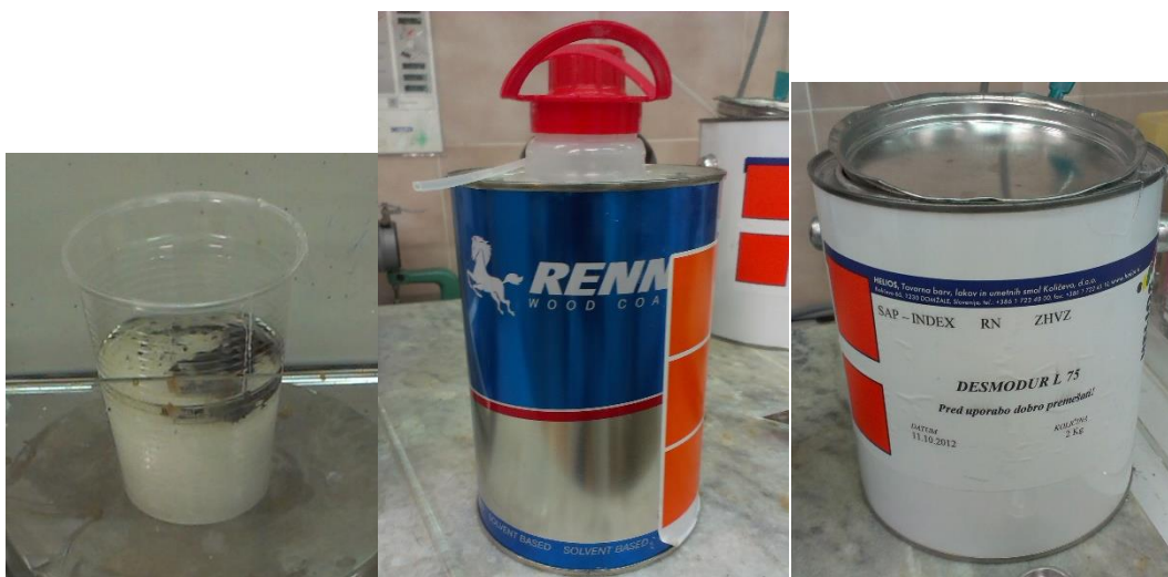
Slika 23: Priprava premaza iz utekočinjenega lesa (levo), PU redčilo (sredina) in DESMODUR L 75 (desno)
