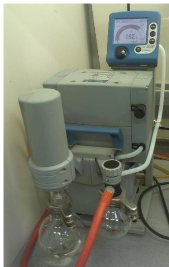
Slika 7: Črpalka za filtriranje utekočinjenega lesa
