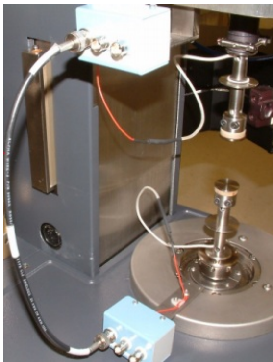
Slika 10: Prikaz priključitve LCR metra na vzporedne diske reometra za merjenje dielektričnih lastnosti
