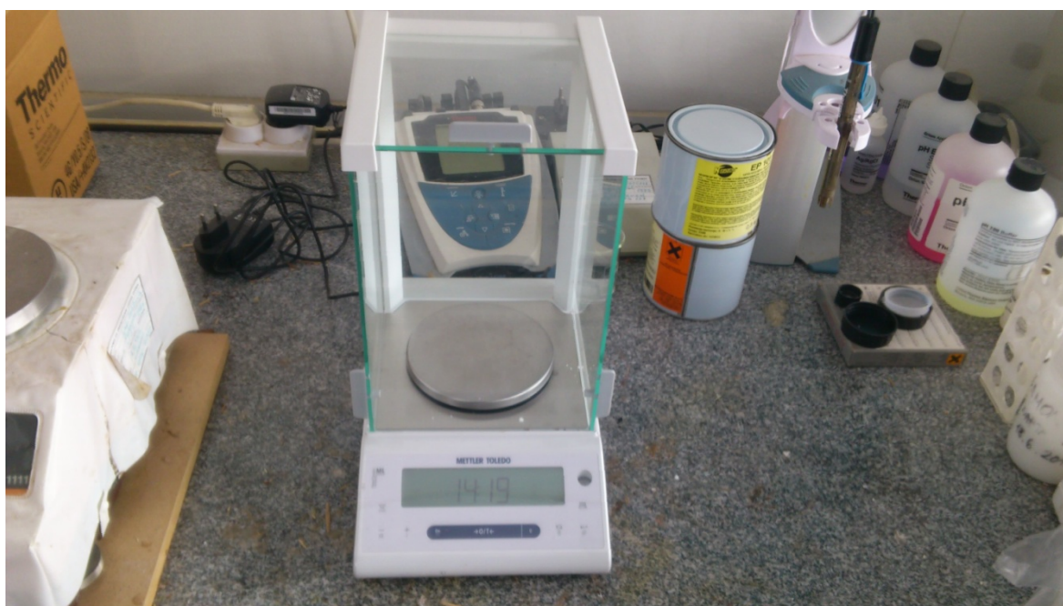
Slika 5: Natančnejša tehtnica za merjenje količine katalizatorja
