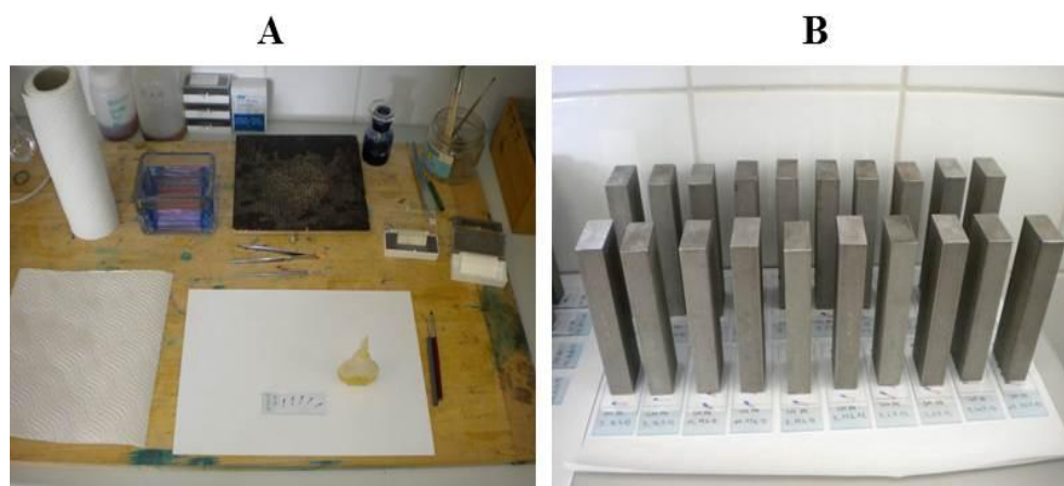
Slika 9: A – Izdelava trajnih mikroskopskih preparatov; B – Sušenje preparatov obteženih z 200 g utežmi.
