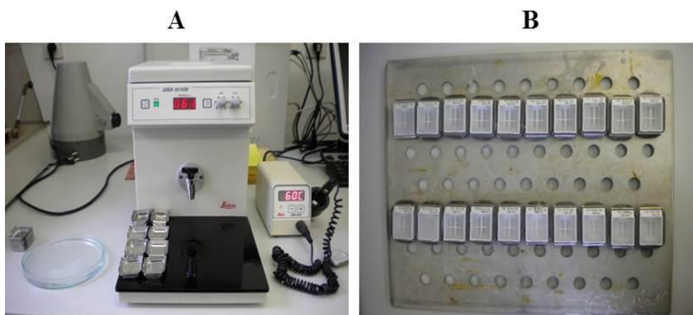
Slika 6: A - Parafinski dispenzer Leica EG 1120 in ogrevalna pinceta Leica EG F; B – ohlajanje vzorcev pri sobni temperaturi.
