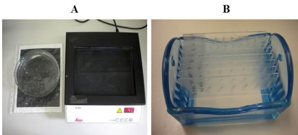
Slika 7: A – Vodna kopel Leica HI 1210 in posoda z mrzlo vodo; B – modro stekleno stojalce za objektna stekelca.
