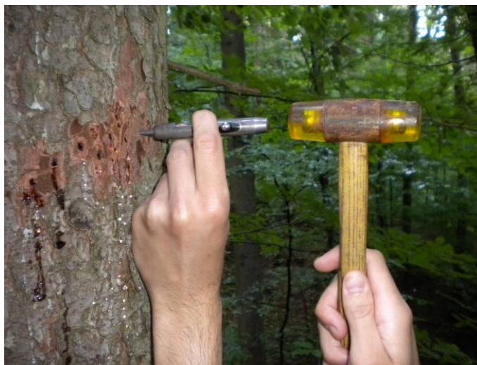
Slika 3: Odvzem mikro izvrtka s pomočjo Trephorja.
