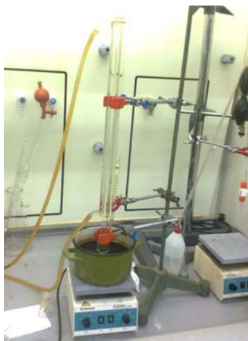
Slika 8: Proces določevanja hidroksilnega števila
