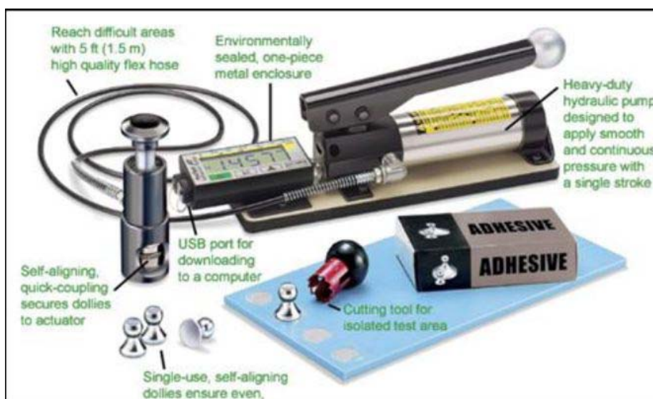
Slika 13: Oprema za izvajanje testa oprijemnosti z odtrgovanjem pečatov (Pavlič, 2010)
