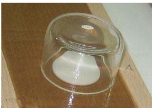
Slika 12: Prikaz preizkušanja odpornosti proti hladnim tekočinam
