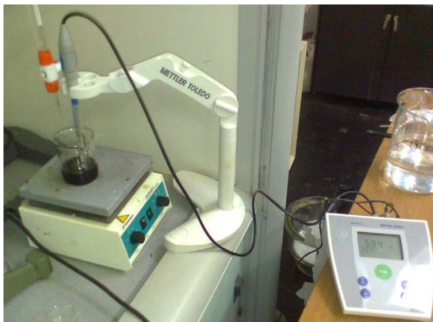
Slika 9: Titriranje in merjenje pH vrednosti
