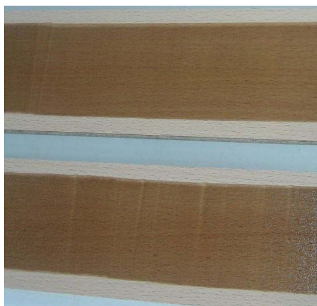
Slika 11: Nanos premaza iz skorje, utekočinjene v polietilen glikolu + glicerolu na leseni podlagi
