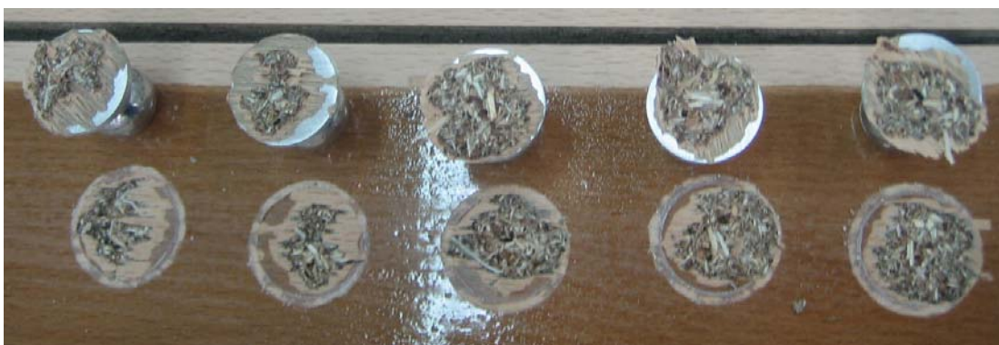
Slika 23: Prikaz kohezijskega loma pri premazu iz utekočinjene skorje
