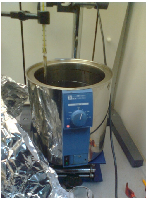
Slika 5: Oljna kad za izvedbo postopka utekočinjenja skorje
