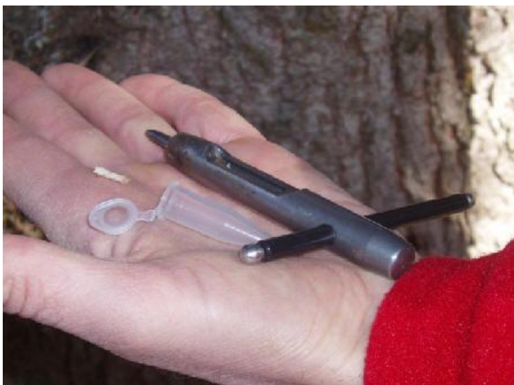
Slika 8: Orodje "Trephor" za odvzem mikro izvrtkov, mikro izvrtke in posoda za fiksiranje takoj po odvzemu in shranjevanje (vir: www.tesaf.unipd.it/Sanvito/ )
