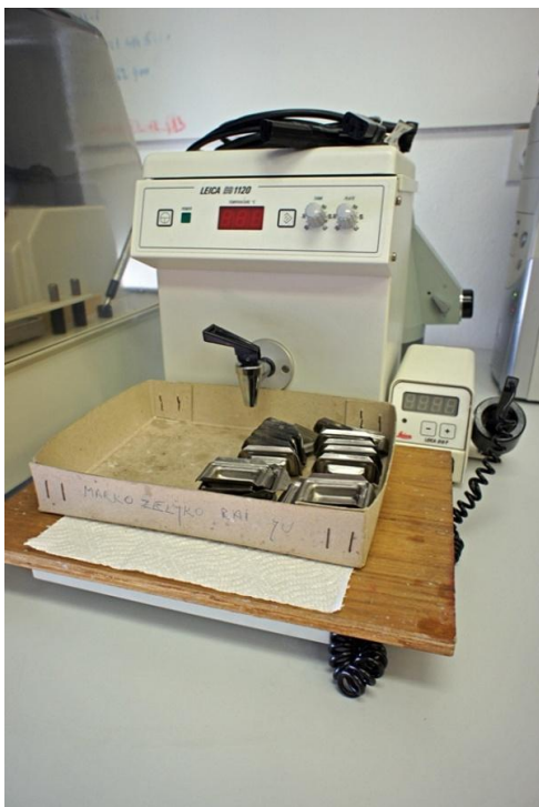
Slika 10: Parafinski dispensor Leica EG 1120 (foto: Vito Kac)
