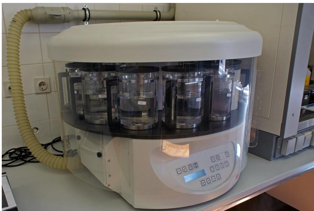
Slika 9: Tkivni infiltrator Leica TP 1020 (foto: Vito Kac)
