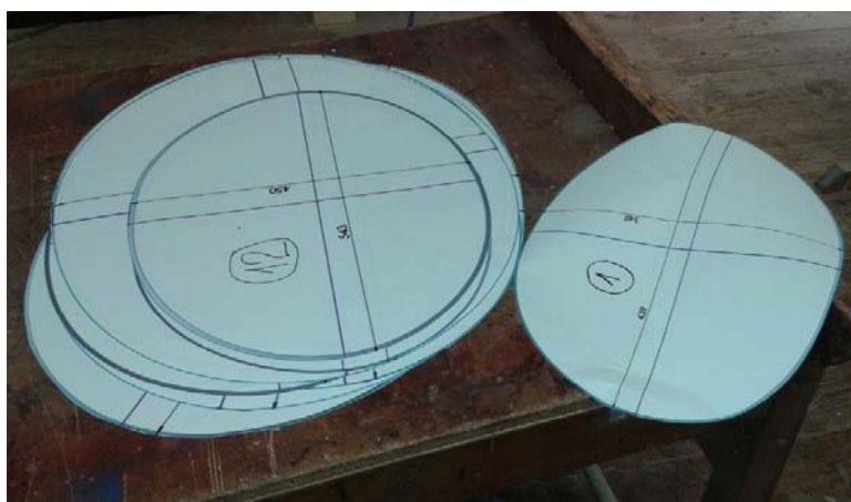
Slika 32: Šablone, po katerih smo obrezali okvirje
