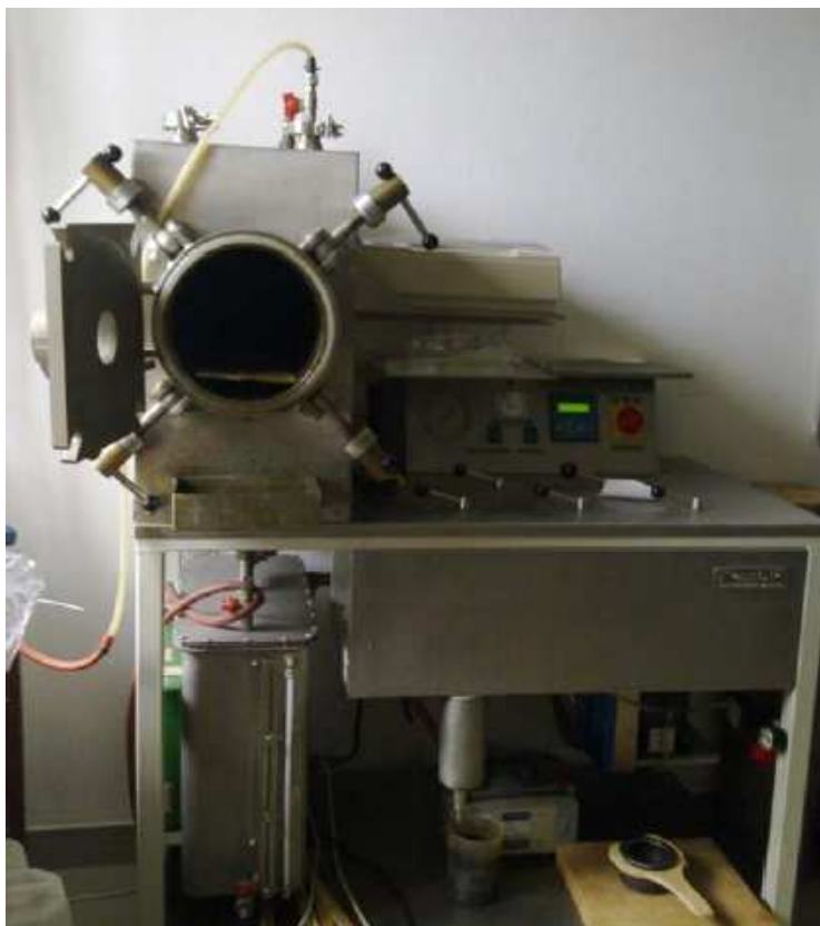
Slika 5: Vakuumsko – tlačna komora Kambič za impregnacijo.
