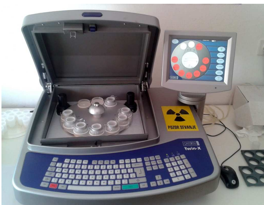
Slika 9: Rentgenski fluorescenčni spektrometer (XRF).
