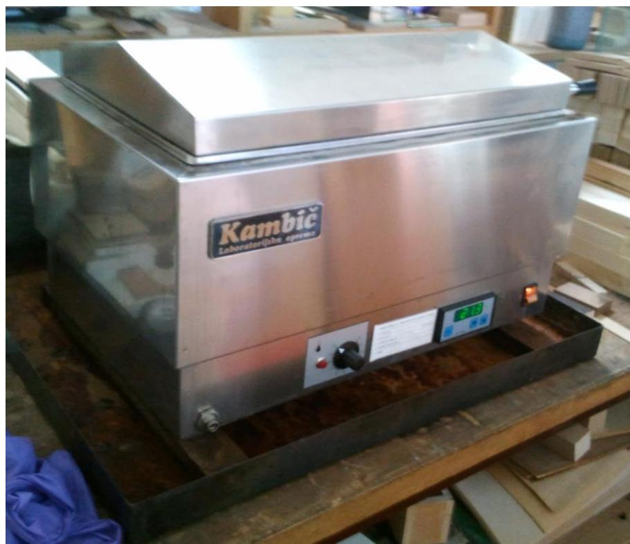
Slika 13 Kuhalnik za kuhanje preskušancev pri 67 °C in 100 °C
