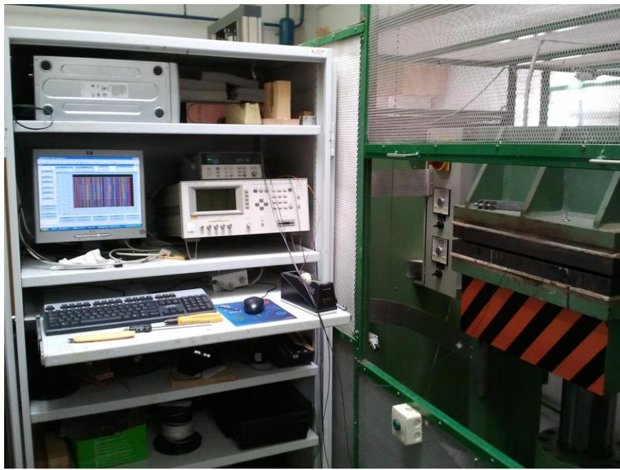
Slika 9 Stiskanje lamel in spremljanje temperature v lepilnem spoju
