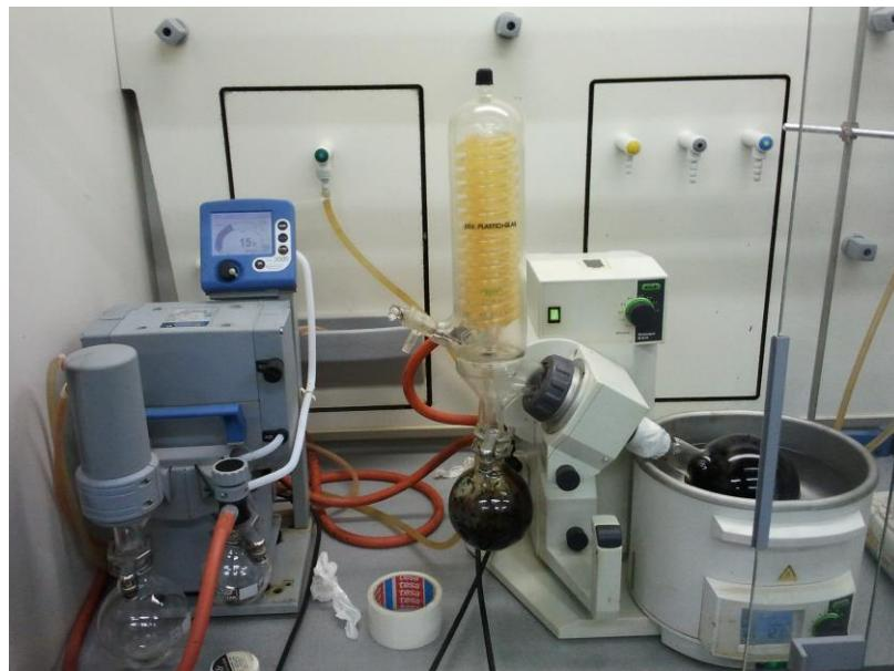
Slika 7 Odparevanje etilen glikola iz utekočinjenega lesa z rotavaporjem
