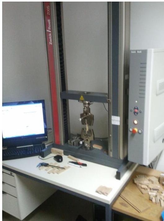
Slika 14 Testirni stroj Zwick/Roell Z005
