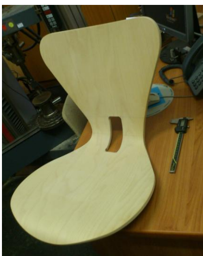
Slika 16: Lupina B z odvzetim materialom širine 50 mm
