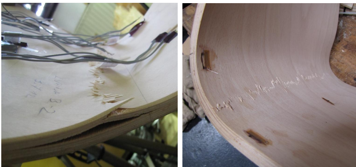
Slika 23: Razplastitev (levo) in natezna porušitev zunanjega sloja (desno)
