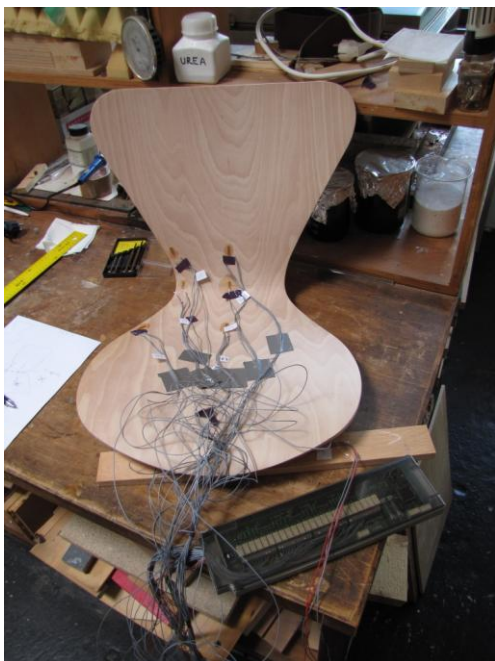
Slika 19: Na lupino prilepljeni uporovni lističi ter enota za zajem podatkov Agilent
