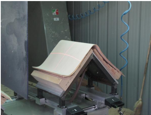
Slika 9: Pozicioniranje lupin (levo) ter obrezovanje le-teh (desno)
