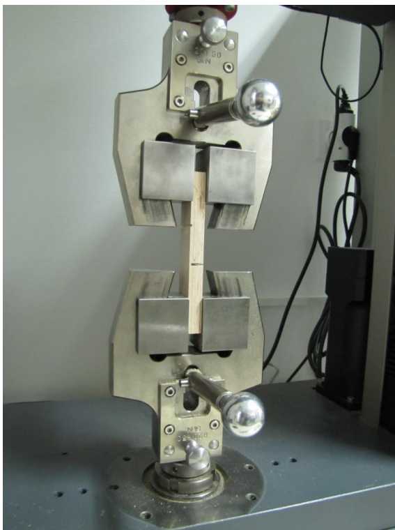
Slika 21: Vpetje preizkušanca v čeljusti trgalnega stroja
