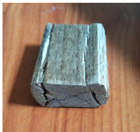
Slika 21: Vzorec po testiranju tlačne trdnosti
