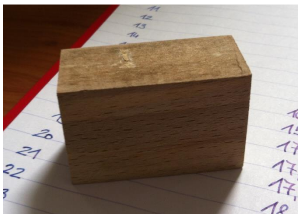
Slika 20: Vzorec pred testiranjem tlačne trdnosti
