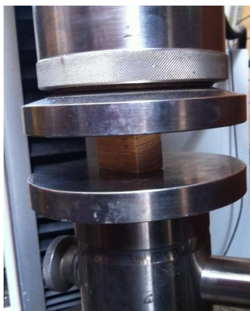
Slika 18 in Slika 19: Testirni stroj Zwick Z100 za določanje tlačne trdnosti vzorcev
