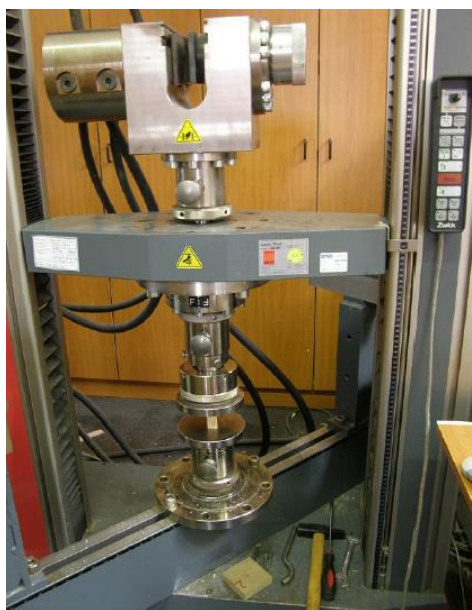
Slika 18 in Slika 19: Testirni stroj Zwick Z100 za določanje tlačne trdnosti vzorcev
