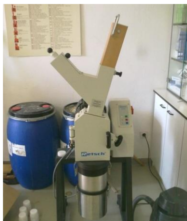
Slika 7: Mlin za mletje Retsch SM 2000
