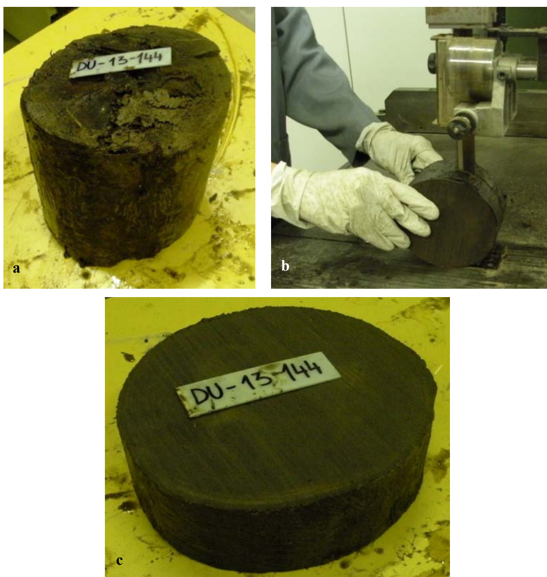
Slika 13: Obdelava vzorcev lesa: (a) vzorec lesa z identifikacijsko številko pred obdelavo, (b) obdelava vzorca z mizarskim strojem, (c) kolut, izžagan iz sredine vzorca, pripravljen za raziskavo.
