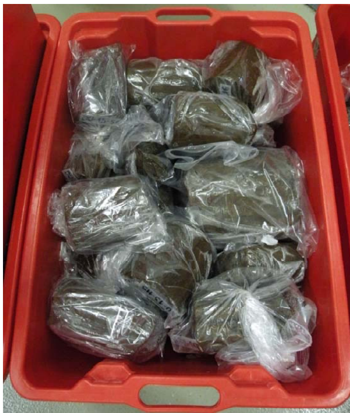
Slika 12: Vzorci lesa po odvzemu na terenu pripravljeni za obdelavo z mizarskimi stroji. 10 do 20 cm dolgi vzorci so označeni z identifikacijskimi številkami in nepredušno zaprti v polietilenskih vrečkah.
