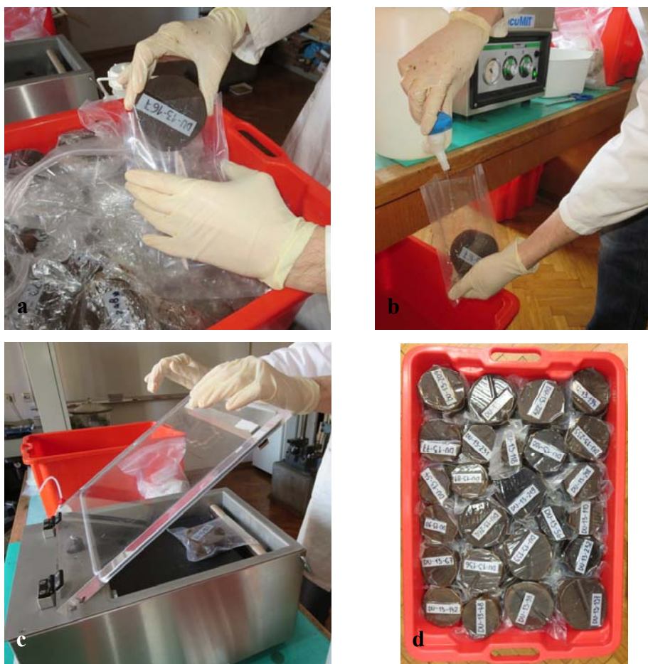
Slika 19: Priprava vzorcev na skladiščenje: (a) vlaganje vzorca v debelo polietilensko folijo, (b) prilivanje destilirane vode, da vzorec ostane napojen, (c) vzorec v napravi za vakuumsko pakiranje in (d) vzorci pripravljeni na skladiščenje v depojih Oddelka za lesarstvo.
