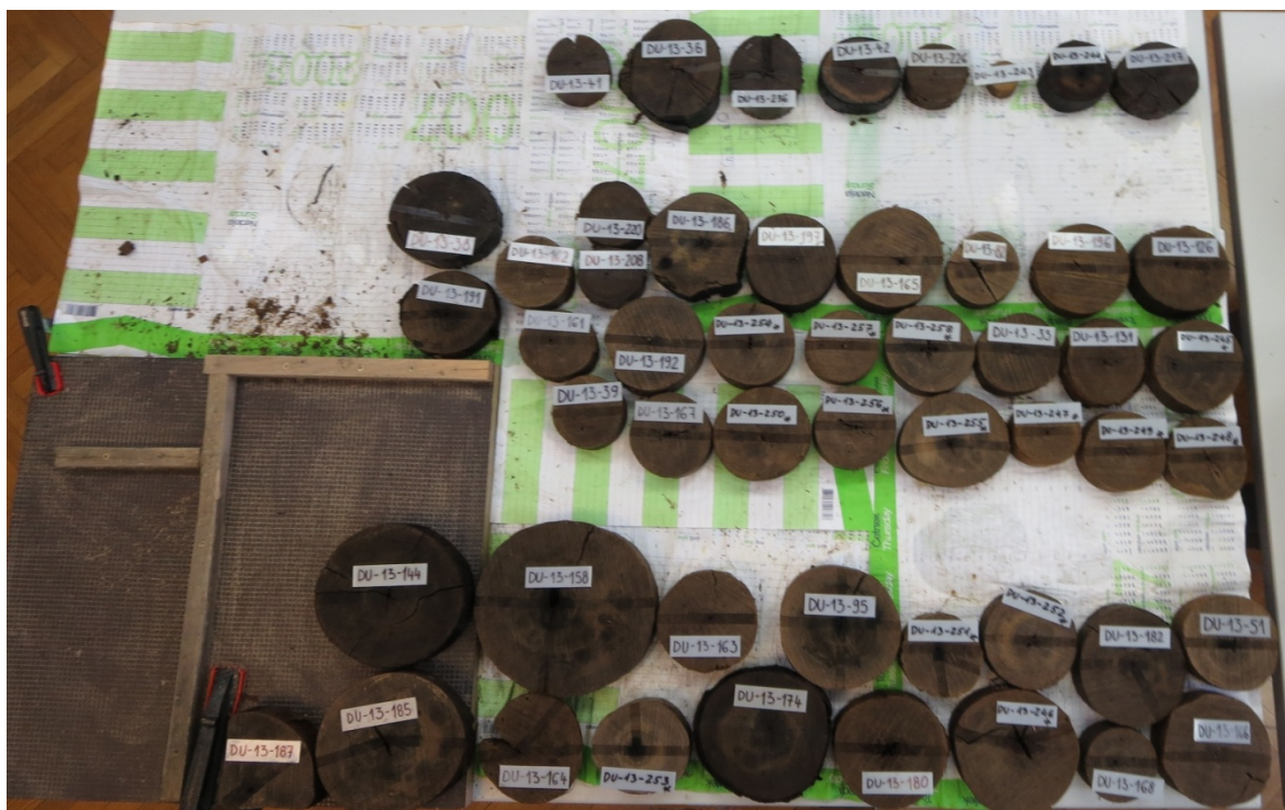
Slika 15: Vzorci po makroskopskem pregledu razdeljeni v tri skupine: na vrhu so vzorci, pri katerih z makroskopsko metodo nismo mogli določiti lesene vrste, na sredini so makroskopsko identificirani vzorci, spodaj pa makroskopsko identificirani vzorci jesena z vsaj 45 branikami, pripravljeni za dendrokronološko analizo.
