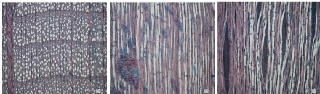
Slika 5: Ksilotomske ravnine (prečni prerez, radialni prerez in tangencialni prerez) navadne bukve pod mikroskopom (foto: Majer, A.).
