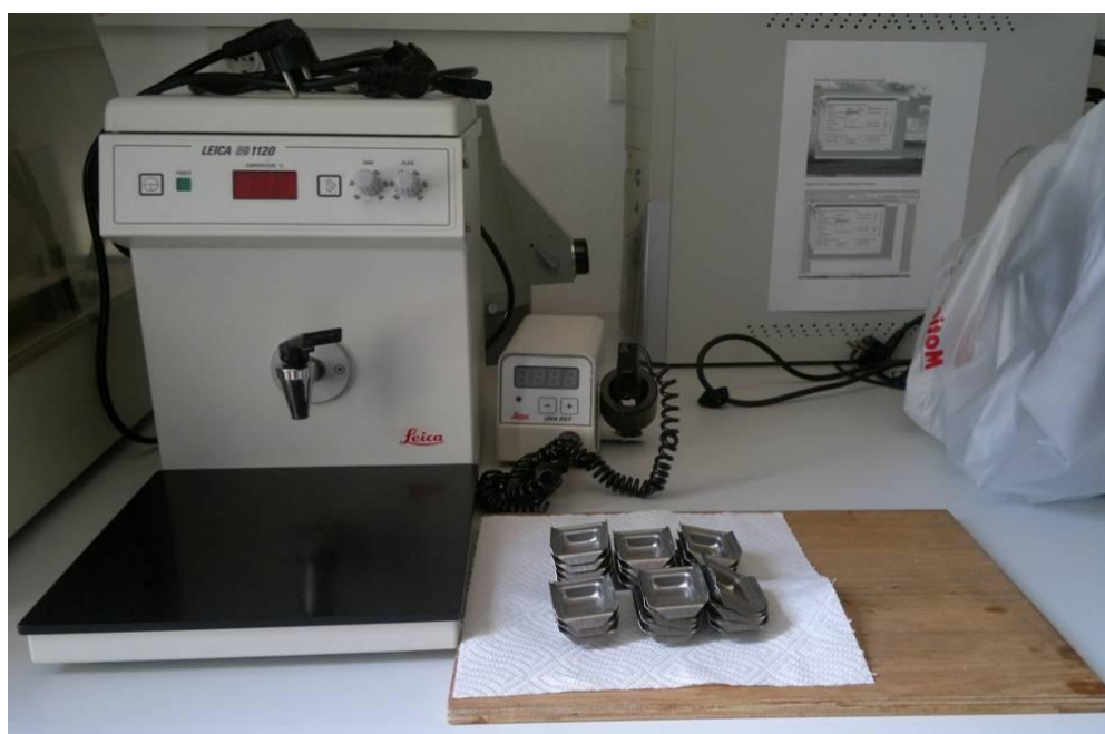
Slika 13: Parafinski dispenzer Leica EG 1120 levo, pinceta Leica EG F zadaj in kovinske kasete spredaj (foto: Majer, A.).
