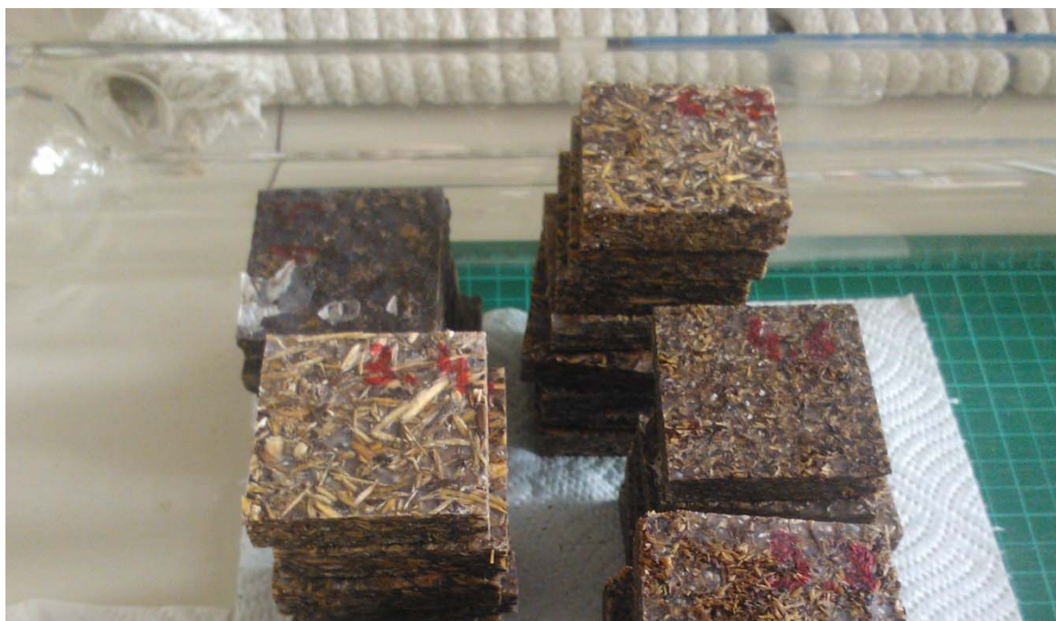
Slika 13: Na sliki lahko vidimo razlike v površinah, kjer so nekatere povsem »zaprte« s plastično maso, nekatere pa nekoliko manj. To se pozna pri nabreku, ki je pri slednjih seveda višji.
