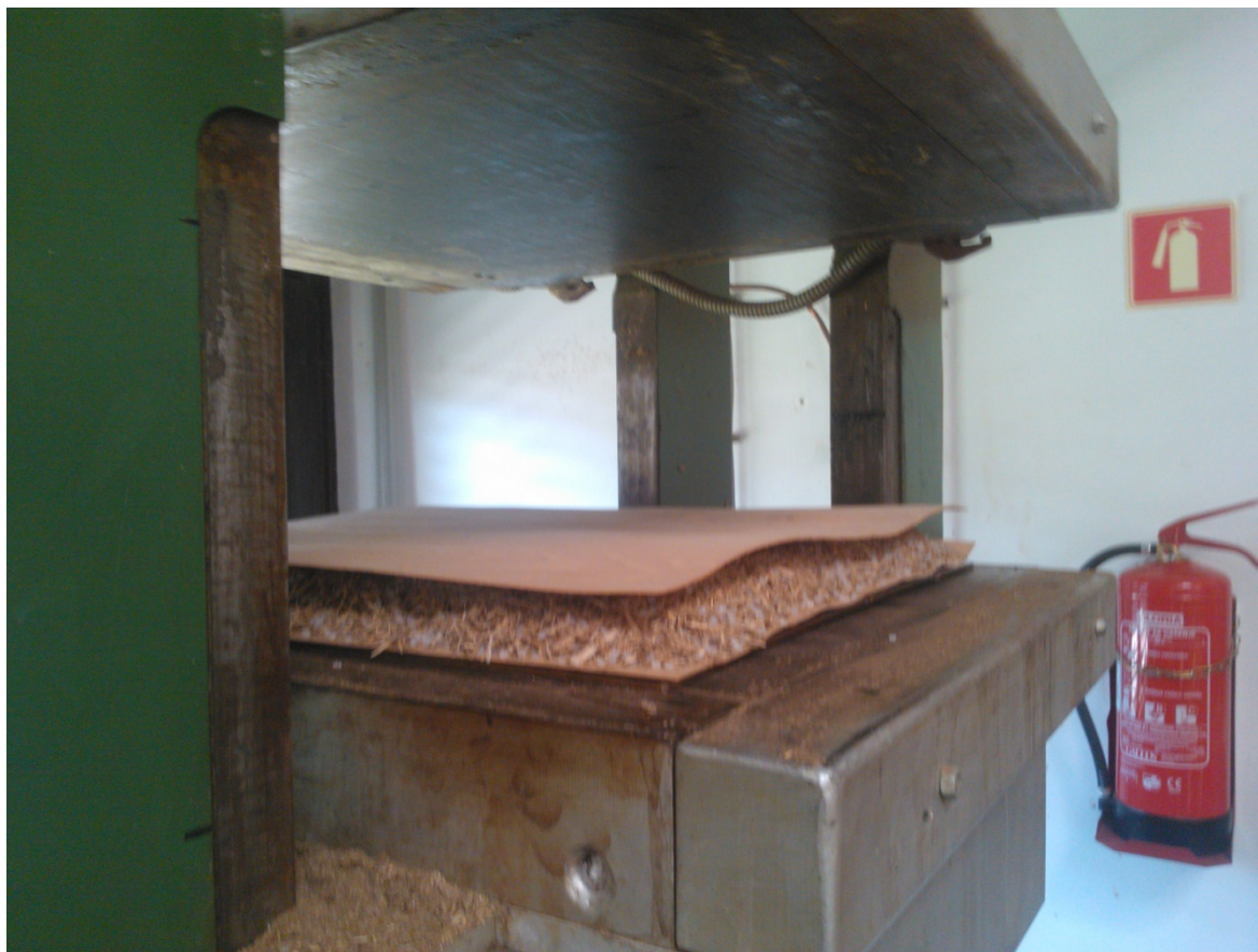
Slika 9: Lesno plastična mešanica v stiskalnici obdana s furnirjem pred stiskanjem
