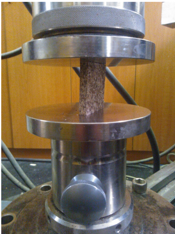
Slika 14: Testiranje tlačne trdnosti vzorcev z napravo Zwick Roell
