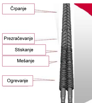
Slika 4: Shematski prikaz dvojnega rotacijskega sistema z vijakoma, ki sta postavljena konično
