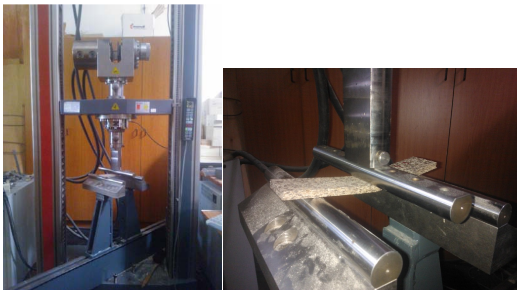
Sliki 10 in 11: Testiranje upogibne trdnosti na napravi Zwick Roell
