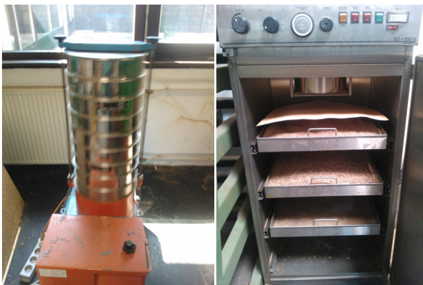
Sliki 6 in 7: Laborijski sejalnik in peč za sušenje iveri.
