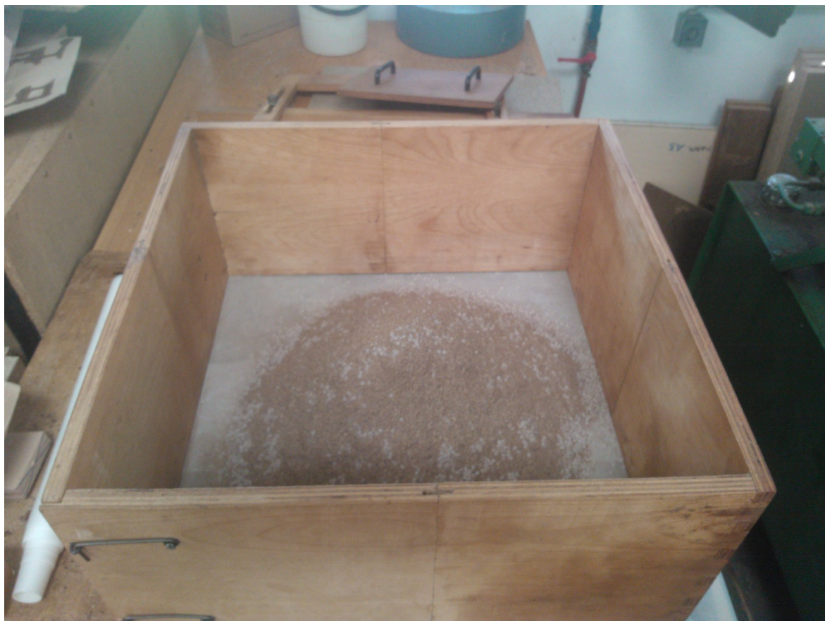
Slika 8: Lesen kalup z mešanico lesenih iveri in plastične mase
