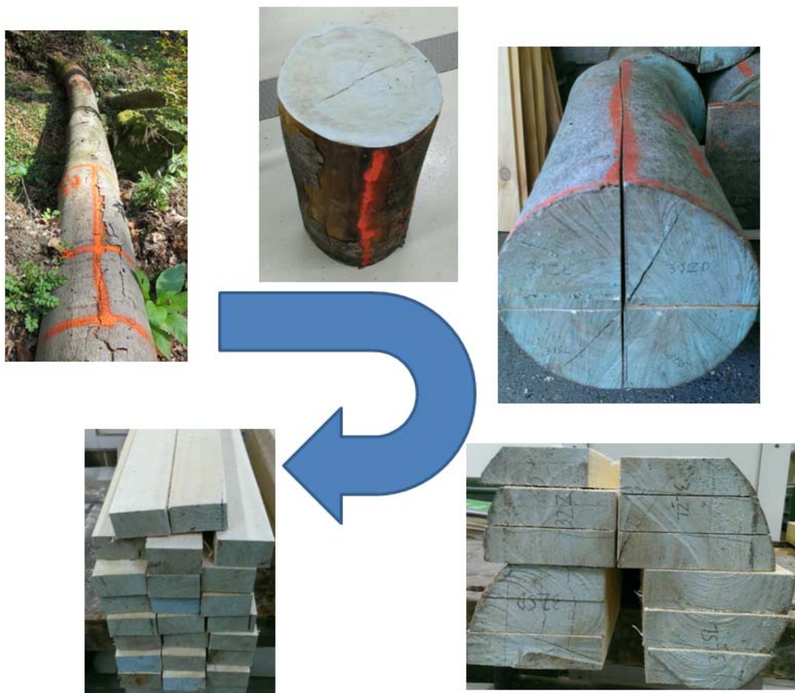
Slika 10: Vrstni red obdelav za pripravo preizkušancev (foto: Marela, Plavčak)
