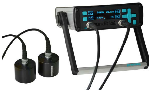
Slika 14: Merilni inštrument PunditLab za merjenje hitrosti ultrazvoka (vir: http://www.proceq.com/ )
