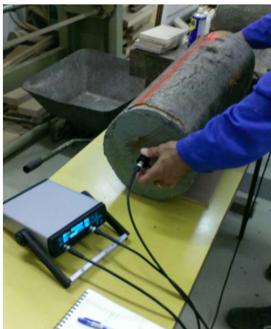
Slika 15: Meritev hitrosti ultrazvoka pri hlodičku (foto: Plavčak)
