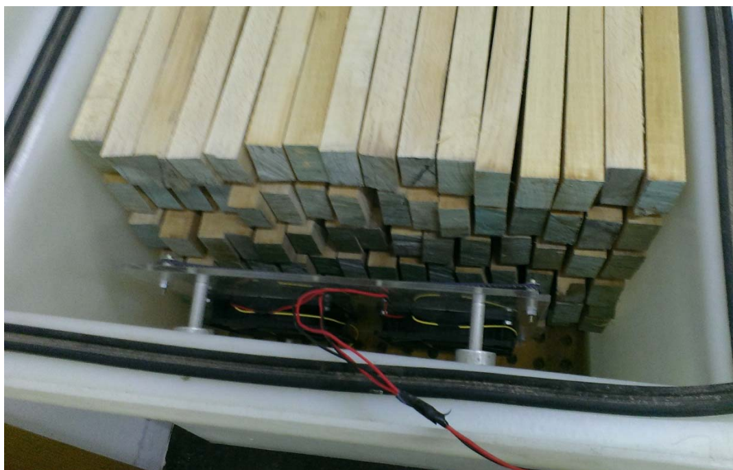
Slika 13: Vzorci D strani hlodička v kadi nad solno raztopino \text{NaNO}_2 z dodatnim ventilatorjem za prisilno kroženje zraka (foto: Plavčak)
