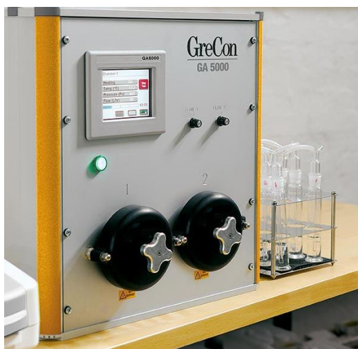
Slika 4: Aparatura za plinsko analizo emisije prostega formaldehida
