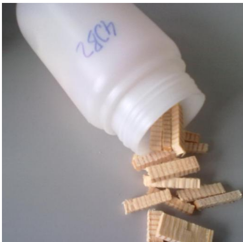
Slika 13: Preizkušanci, pripravljeni za mletje na laboratorijskem mlinu.
