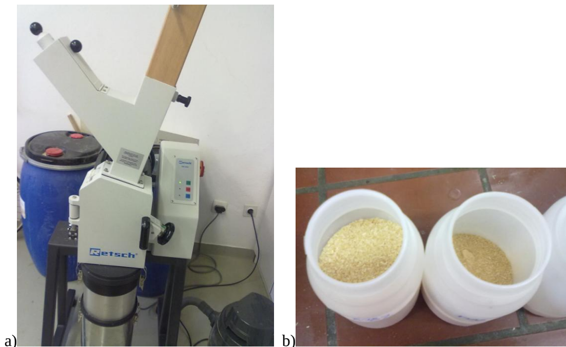
Slika 14: Slika a prikazuje laboratorijski mlin Retsch SM 2000, slika b pa preizkušance po mletju.
