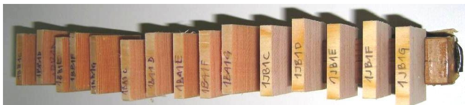
Slika 9: Ustrezno označeni preizkušanci za določevanje dimenzijske stabilnosti in sorpcijskih lastnosti, nameščeni na posebnem nosilcu.
