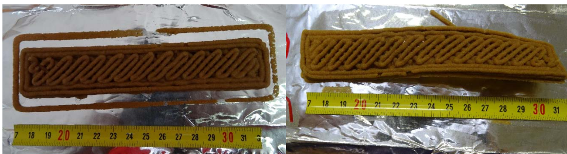
Slika 29: Preizkušanec iz UF-lepila takoj po tiskanju (levo) in po 14 dneh sušenja (desno)
