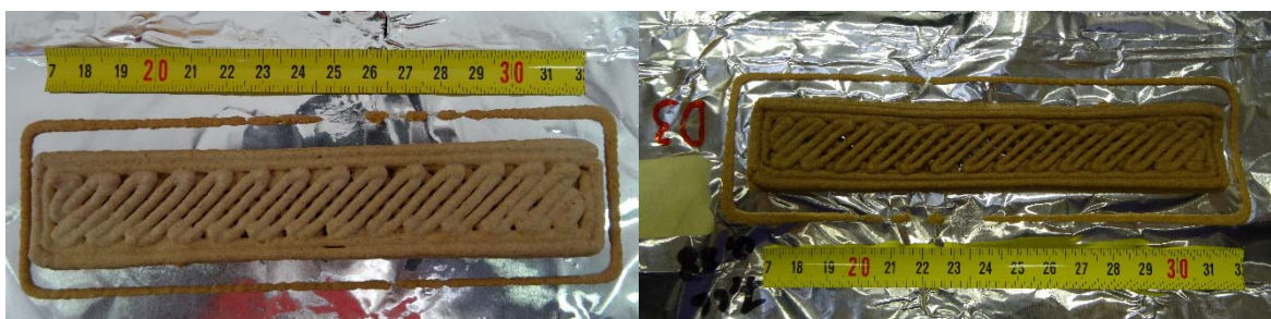
Slika 28: Preizkušanec iz PVAc-lepila takoj po tiskanju (levo) in po 14 dneh sušenja (desno)
