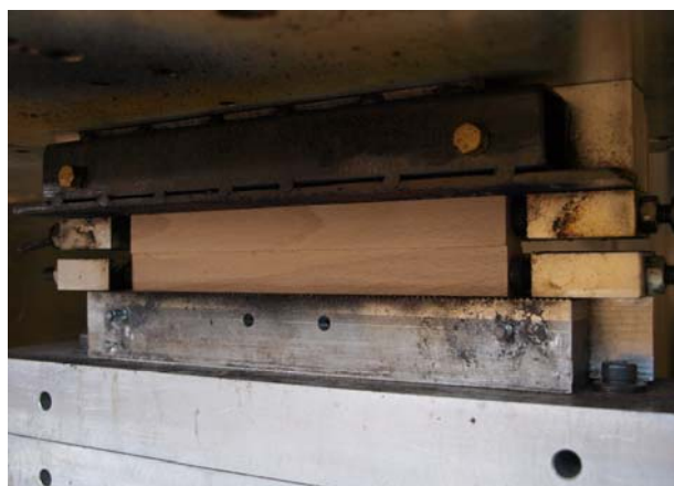
Slika 7: Vzorca lesa, vpeta v čeljusti stroja za varjenje lesa
