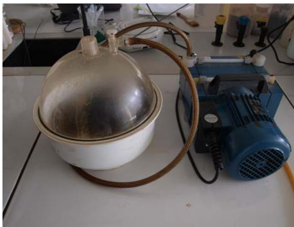
Slika 5: Vakuumsko impregnacija vzorcev z raztopinami kislin
