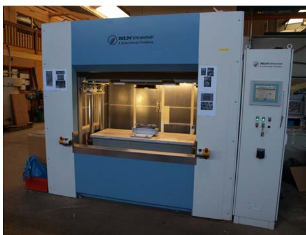
Slika 6: Naprava za linearno torni varjenje lesa KLN Ultraschall LVW-2261
