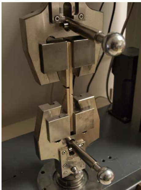
Slika 12: Preizkušanje strižne trdnosti lepilnih in zvarjenih spojev na univerzalnem testirnem stroju ZWICK/Z005
