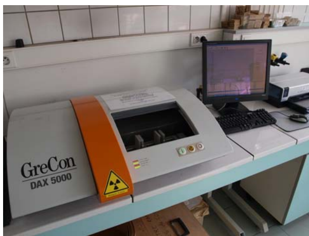
Slika 8: Naprava za merjenje gostotnih profilov z X – žarki GreCon DAX 5000
