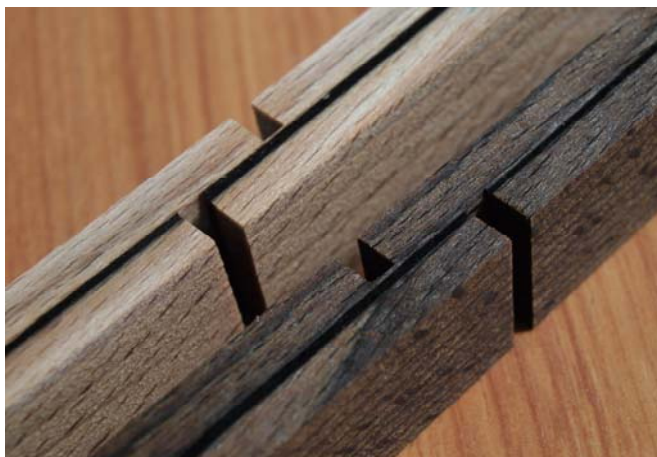
Slika 28: Izgled zvarjenih spojev po 3 urnem kuhanju v vreli vodi in 2 urnem namakanju v hladni vodi
