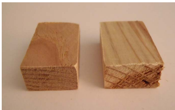
Slika 14: Fini razrez vzorcev kostanja in smreke za določanje kratkotrajnega navzema vode in tlačne trdnosti. Na smrekovem vzorcu so dobro vidni znaki razkrojenosti.
