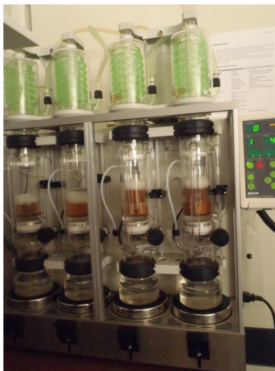
Slika 23: Soxhlet aparat za ekstrakcijo Büchi, B-811
