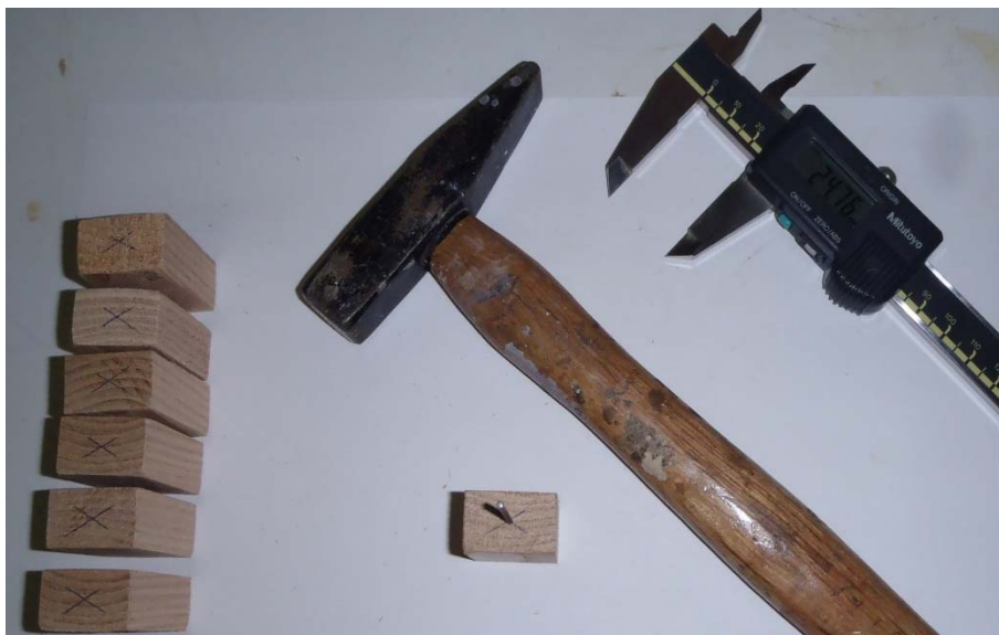
Slika 21: Priprava vzorcev za meritev na tenziometru Krüss 100
