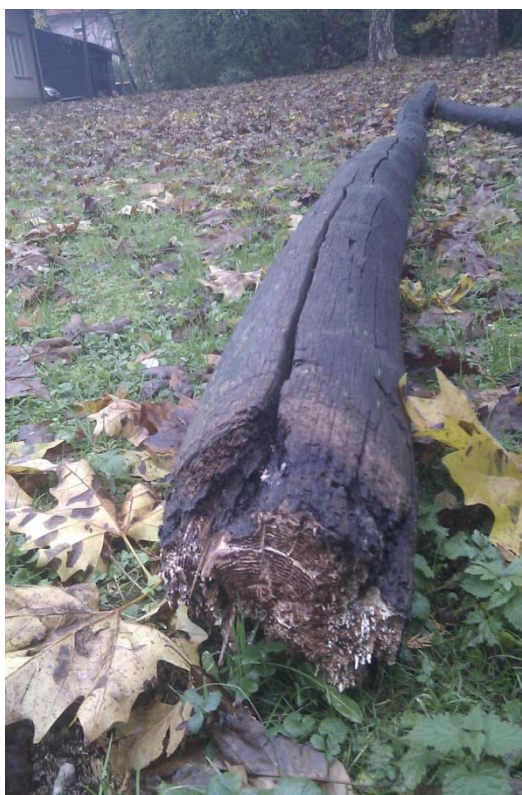
Slika 10: Drog, iz katerega so bili izdelani vzorci v okviru naloge. Del droga v stiku z zemljo je povsem razkrojen, medtem ko je preostali del droga praktično nepoškodovan.
