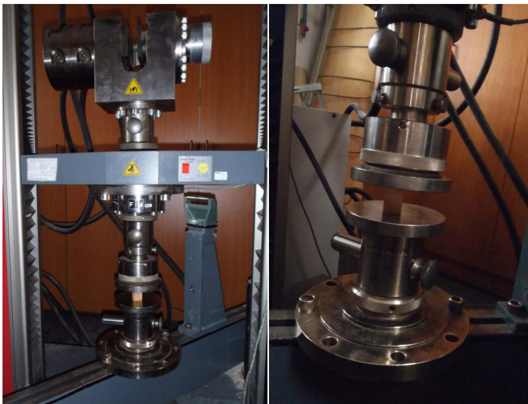
Slika 20: Testirni stroj Zwick Z100 za določanje tlačne trdnosti vzorcev
