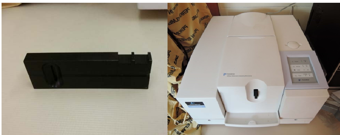
Slika 8: Levo - nosilec v katerega smo vstavili vzorce, desno - spektrometer Spectrum One
