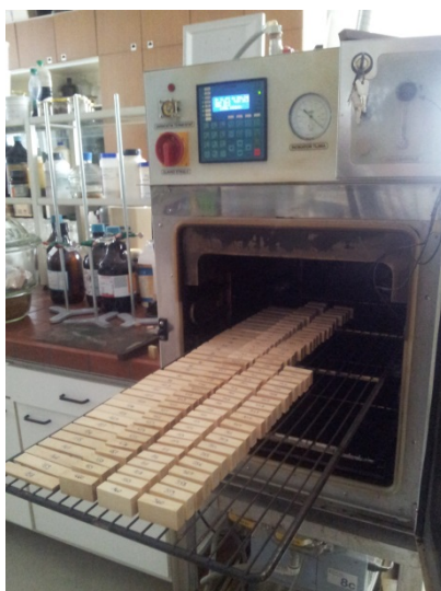
Slika 9: Komora za termično modifikacijo Kambič (foto: K. Zupančič)
