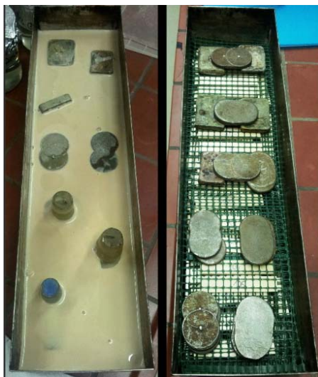
Slika 7: Potapljanje vzorcev v emulzijo voska (foto: K. Zupančič)
