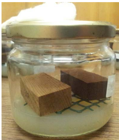
Slika 11: Vzorec na miceliju na začetku 16 tedenske izpostavitve glivam (foto: K. Zupančič)
