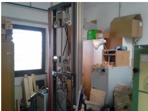
Slika 26: Testirni stroj Zwick za določanje tlačne trdnosti vzorcev
