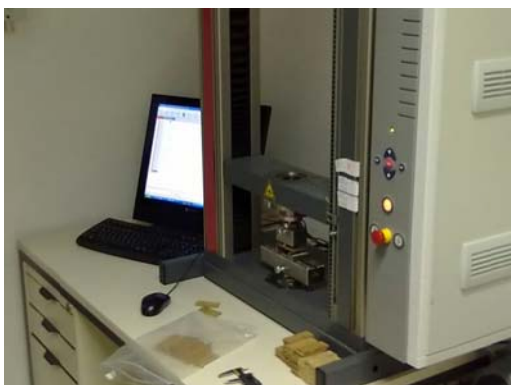
Slika 24: Preizkus upogibne trdnosti vzorcev lesa
